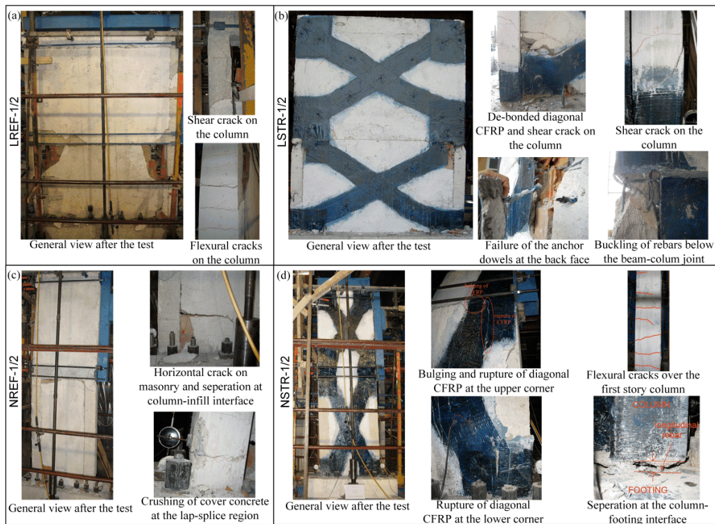
Fig. 7 Failure pattern of the test frames (a) LREF-1/2, (b) LSTR-1/2, (c) NREF-1/2 and (d) NSTR-1/2.
