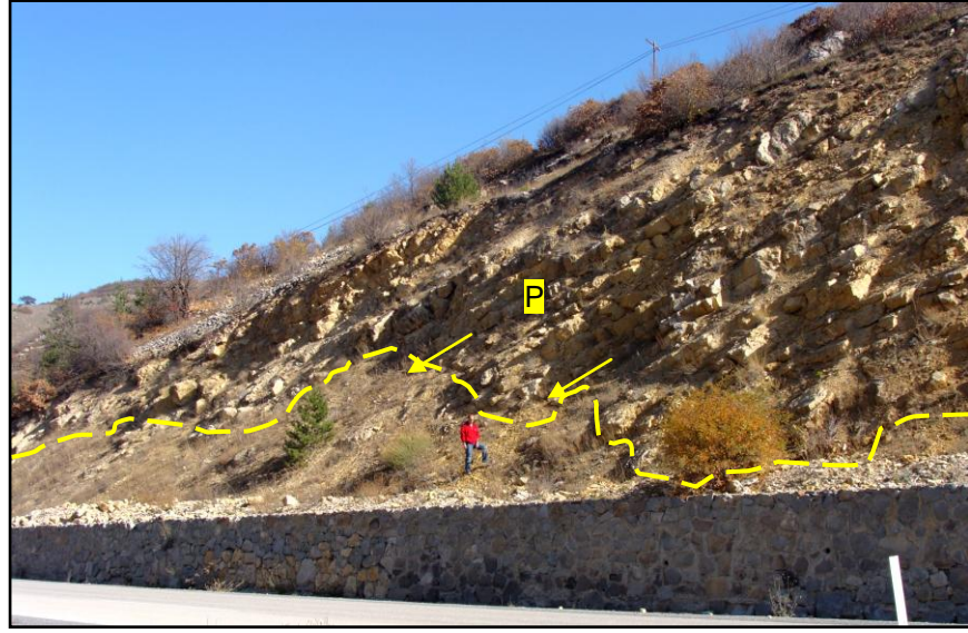
Şekil 4.35. Kireçtaşı formasyonu (Soğukçam Formasyonu, Aktaş bölgesi) ok yönünde düzlemsel kayma potansiyeline sahiptir. (Kuzeydoğuya bakış)
