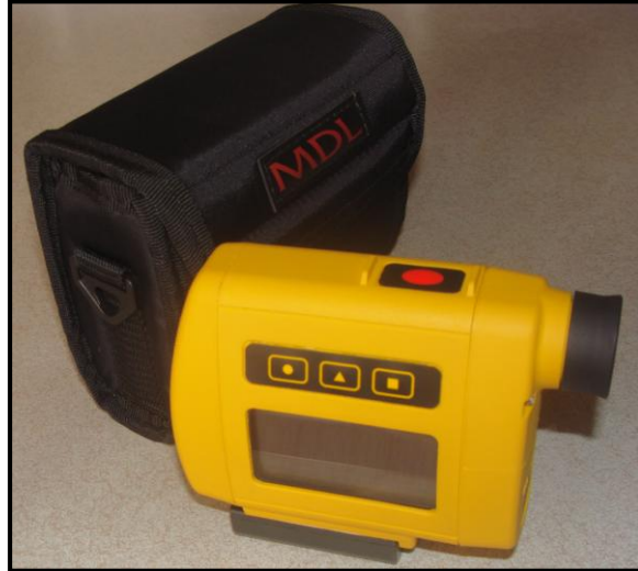
Şekil 3.6. Çalışmada kullanılan hipsometre (MDL marka “LaserAce Hypsometer”).
