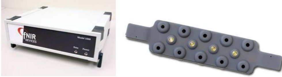
Şekil 1. fNIRS Imager 1000 kontrol kutusu (solda) ve dört LED kızıl-ötesi ışık kaynağı ve 10 algılayıcıya sahip olan fNIRS sensörü.
