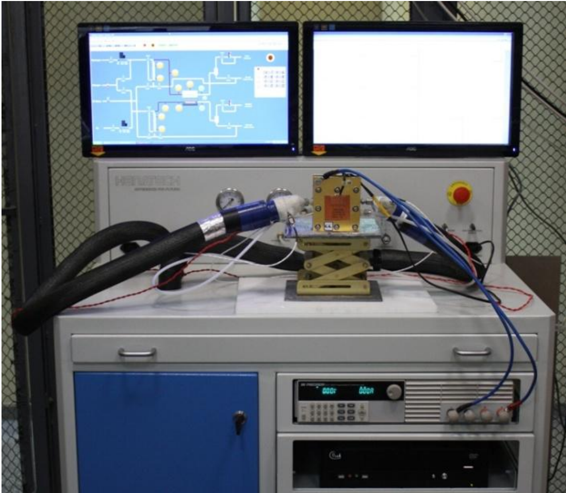
Şekil 4.26 Yakıt pili test istasyonu
