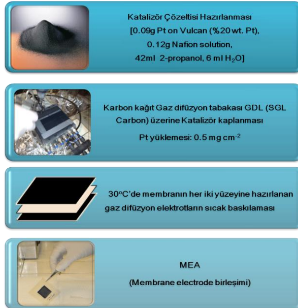
Şekil 4.1. MEA hazırlama 1. Yöntem
