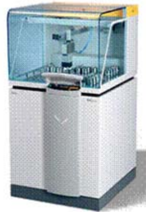
Şekil 3.10. PANalytical AXIOS ADVANCE Dalgaboyu Dağılımlı XRF Spektrometresi
