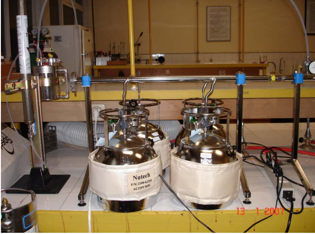
Şekil 3.6. Kanister Temizleme Sistemi
