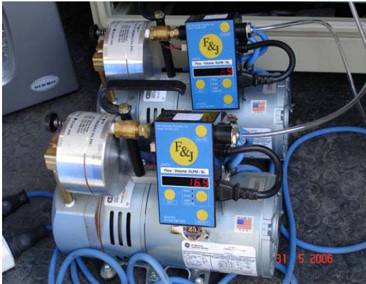
Şekil 3.2.a Düşük Hacimli Hava Örnekleyici (Stack Filter Unit)
