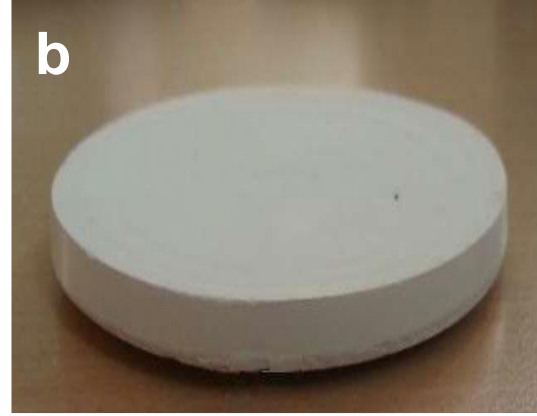
Şekil 3.3. a ve b. Sintelerme işlemi sonrasında sentezlenmiş magnetron hedeflerinin görüntüsü
