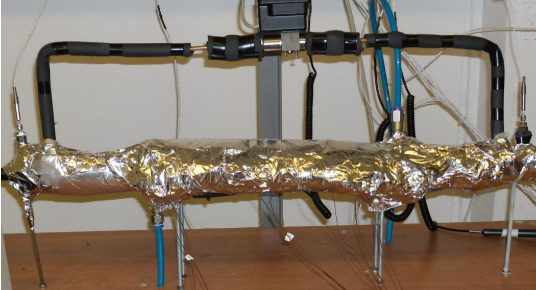
Şekil 22: İzolasyon sonrası bakır boru kullanılan test kısmı
