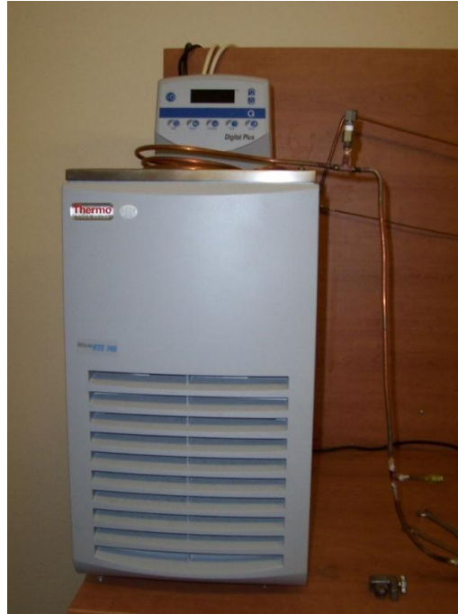
Şekil 7: Soğutkan soğutma banyosu ve helis ısı değiştiricisi
