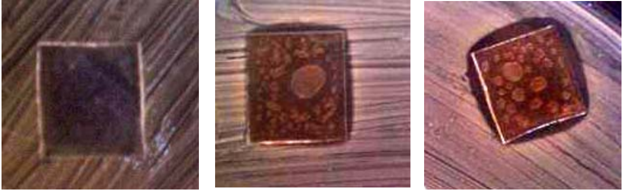
Şekil 4.13 Gümüş aşılınmış antibakteriyel solüsyon ile farklı sayılarda a) 1-kat, b) 3-kat ve c) 5-kat kaplandıktan sonra 300°C'de 2 saat süresince ısı işleme maruz bırakılan cam altlıkların Staphylococcus Aureus (gram pozitif) bakteri çeşidine karşı antibakteriyel test sonuçları
