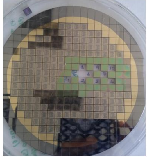
Şekil 4.17 Çift taraflı Au-Sn alaşımı kaplanmış, şekillenmiş olarak ötektik paketleme yapılan numunenin kesme testi sonuçları ve aseton testi sonrası aseton geçirmeyen bölgelerde kesme numunelerinin pozisyonları.
