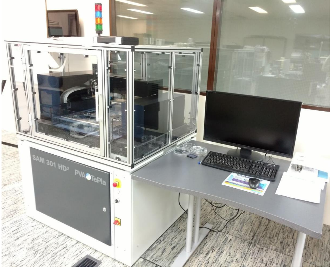
Şekil 3.7 PVA TePla firmasından temin edilen SAM 301 HD model taramalı akustik mikroskop cihazı
