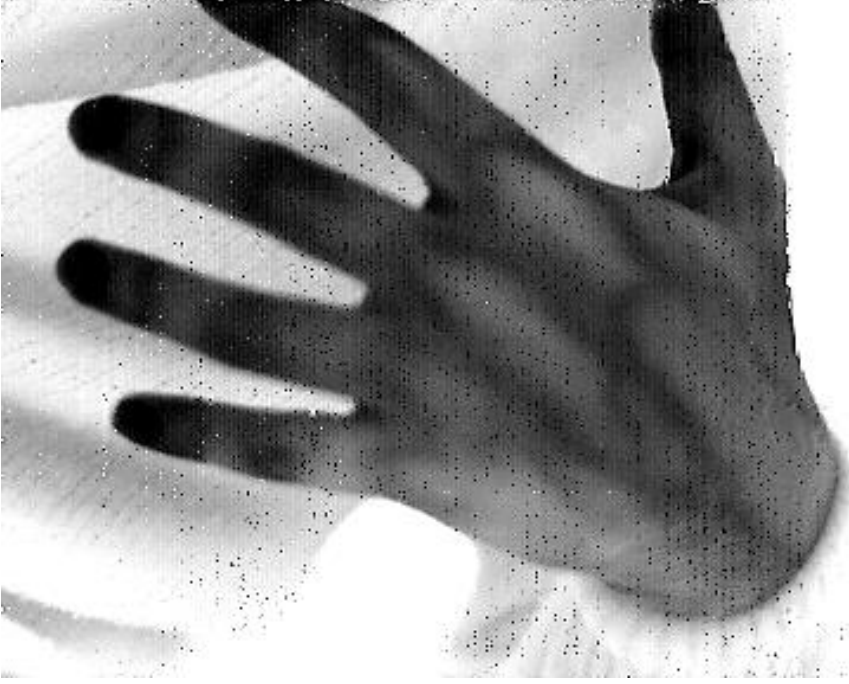
Şekil 4.63 51 nolu sensörden dewar içinde MEMS referans kullanılarak alınmış, 2-nokta düzeltme ve ölü piksel filtreleme uygulanmış termal görüntü.
