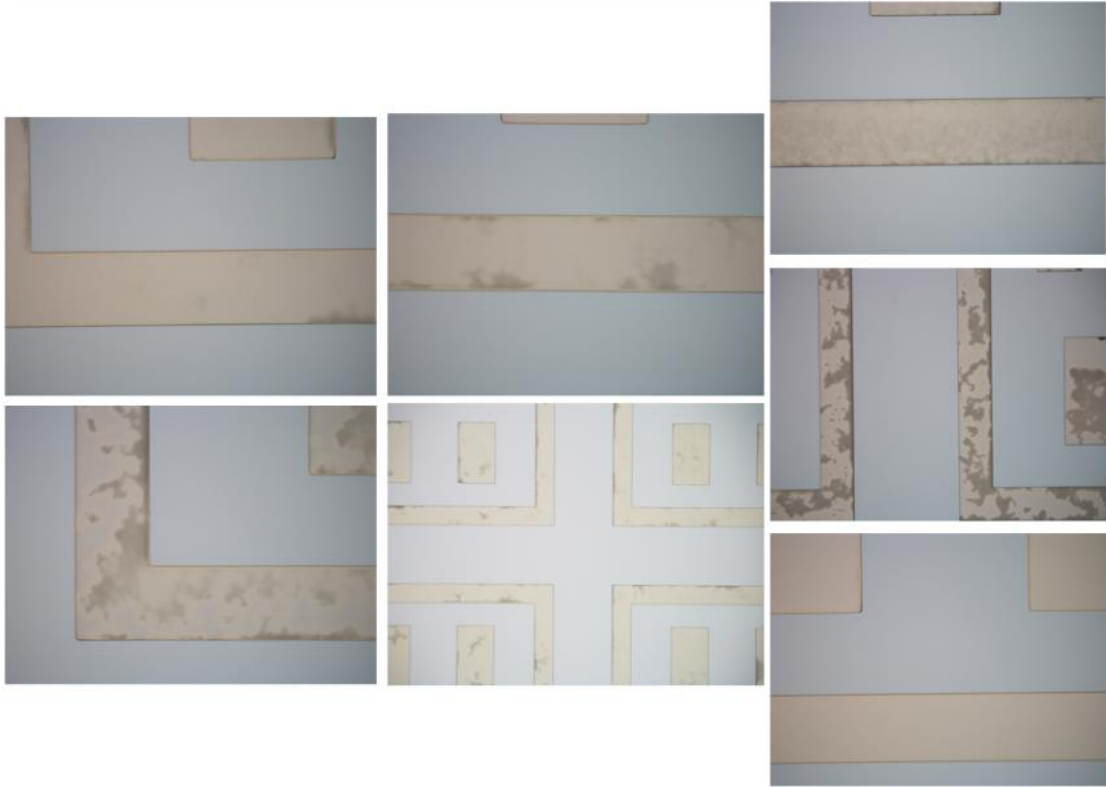
Şekil 4.27 TLP ile paketlenen 5 MPa basınçla paketlenen numunenin paketleme sonrası optik mikroskop görüntüleri.
