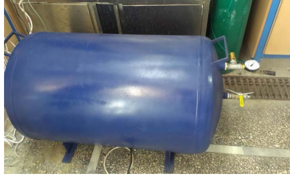
Şekil 8. Baca gazının toplandığı tüp (Hacim 200 L)
