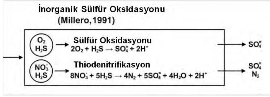
Şekil 16. İnorganik sülfür oksidasyonu dinamiklerinin şematik gösterimi
