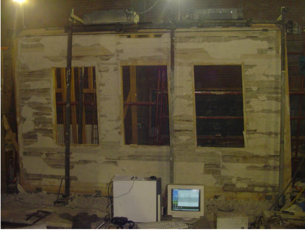
Şekil 261: Çerçevenin deney sonrası hali
