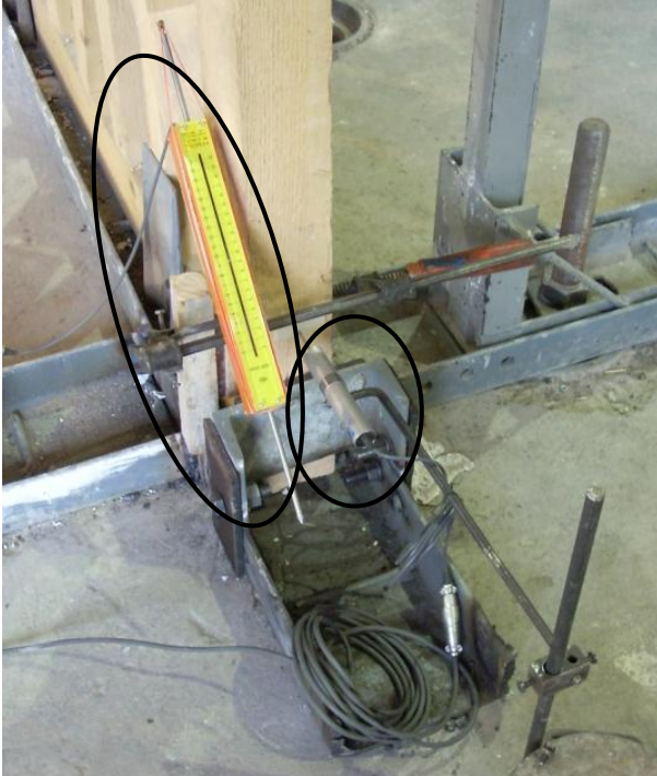
Şekil 12: Çerçevenin yüklemenin yapıldığı tarafına çapraz bağlı bir adet 200 mm'lik ve yatay bağlı bir adet 50 mm'lik LVDT
