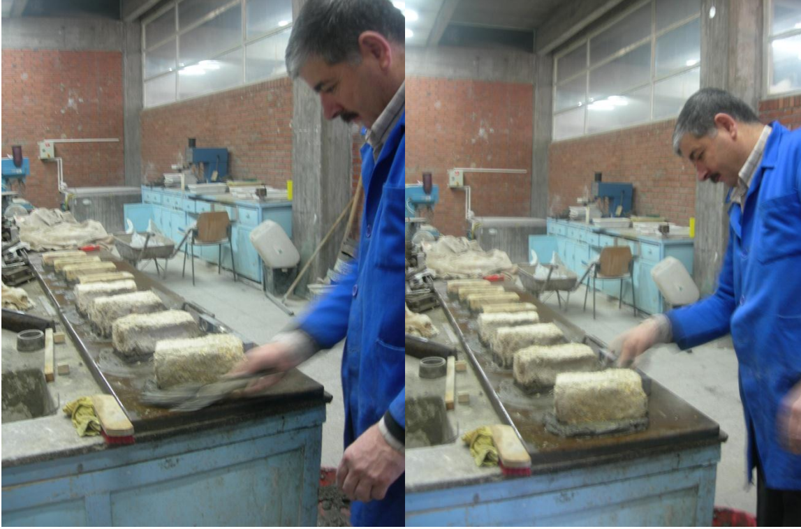
Şekil 311: Yanlarda biriken fazla harcın alınması
