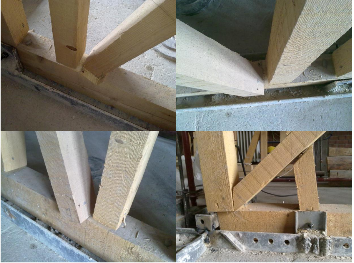
Şekil 144: Sekizinci çerçevenin boş halde test edilmesinin ardından ahşap elemanlarda birbirlerine göre meydana gelen düzlem dışı kalıcı oynamalar
