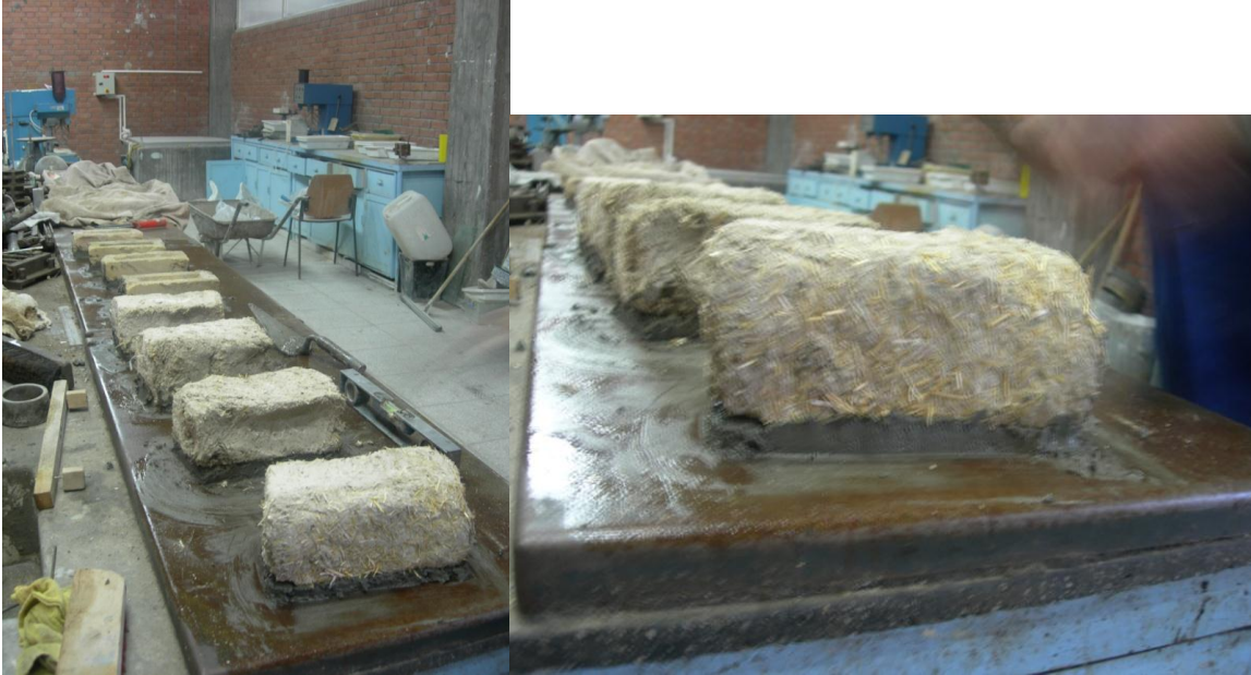
Şekil 312: Diğer tarafına da aynı işlem uygulanmadan evvel başlıkların kurutulmak üzere bekletilmesi
