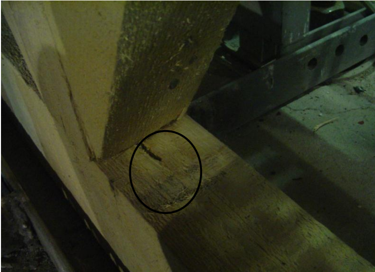
Şekil 47: Çivinin çerçeve yer değiştirirken ahşapta bıraktığı iz
