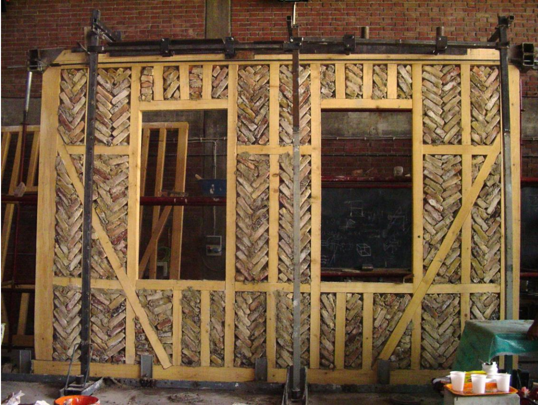
Şekil 265: Dolgusu bitmiş, sıvanmaya hazır haldeki çerçeve
