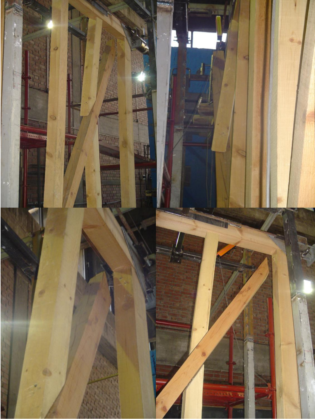
Şekil 62: Birbirinden tamamen ayrılan elemanlar
