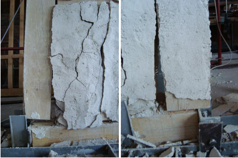
Şekil 281: Deney sonrası içi dolu yedinci çerçevenin durumu
