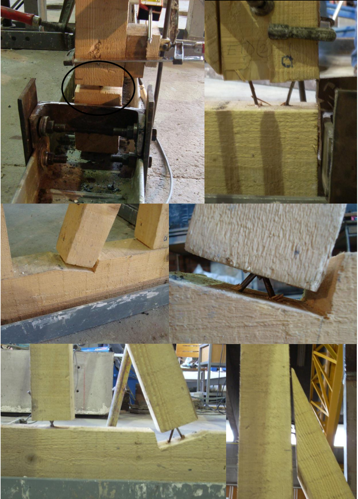
Şekil 30: Deney sırasında çivilerin yerlerinden sökülmesi
