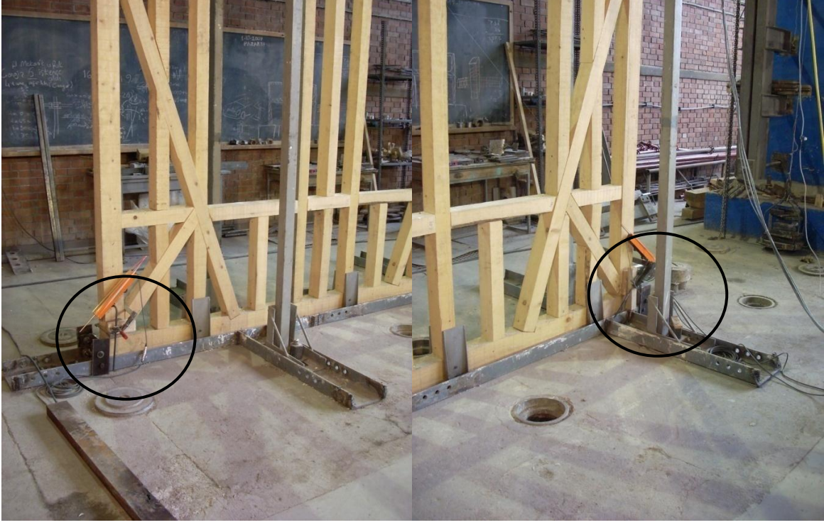
Şekil 11: Çerçevenin her iki yanında yer alan ve diagonal yer değiştirmeyi ölçmek için yerleştirilmiş 200 mm'lik LVDT'ler
