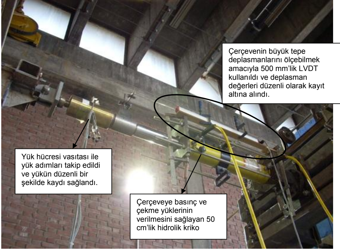
Şekil 13: Çerçevenin tepe deplasmanının ölçümü için yerleştirilmiş 500 mm'lik LVDT
