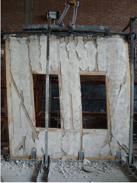
Şekil 223: Deney sırasında sıvaların dökülmesi
