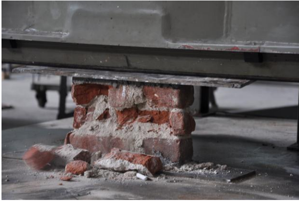
Şekil 316: Numunelerin kırıldıktan sonraki hali
