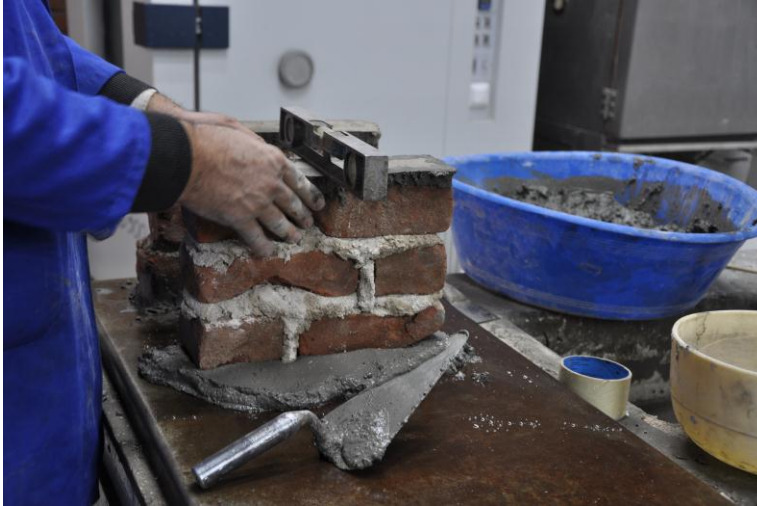
Şekil 314: Başlık yüzeyinin düzgünlüğünün su terazisiyle kontrol edilmesi
