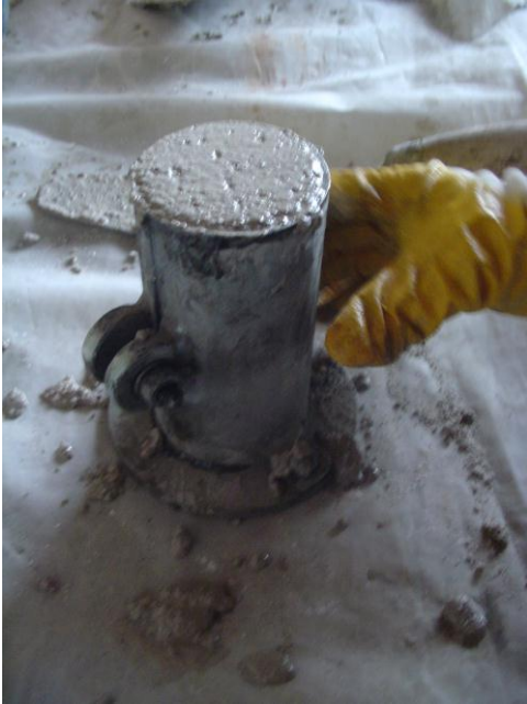
Şekil 267: Harç ve sıva örnekleri 7.5 cm (r) x 15 cm (h) boyutlarında standart silindirlerle toplandı.
