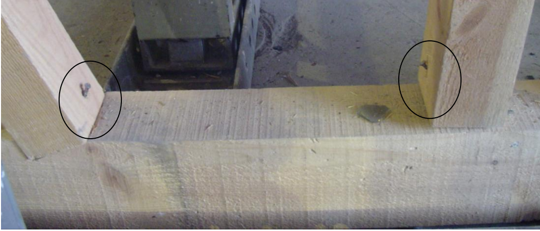
Şekil 77: Deney sırasında yerinden kalıcı olarak çıkmış olan çiviler
