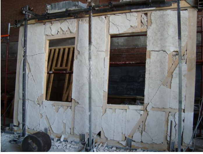
Şekil 281: Deney sonrası içi dolu yedinci çerçevenin durumu
