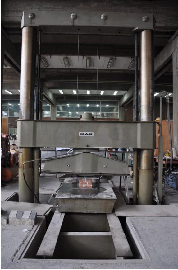
Şekil 315: Yığıma numunelerin test edildiği alet
