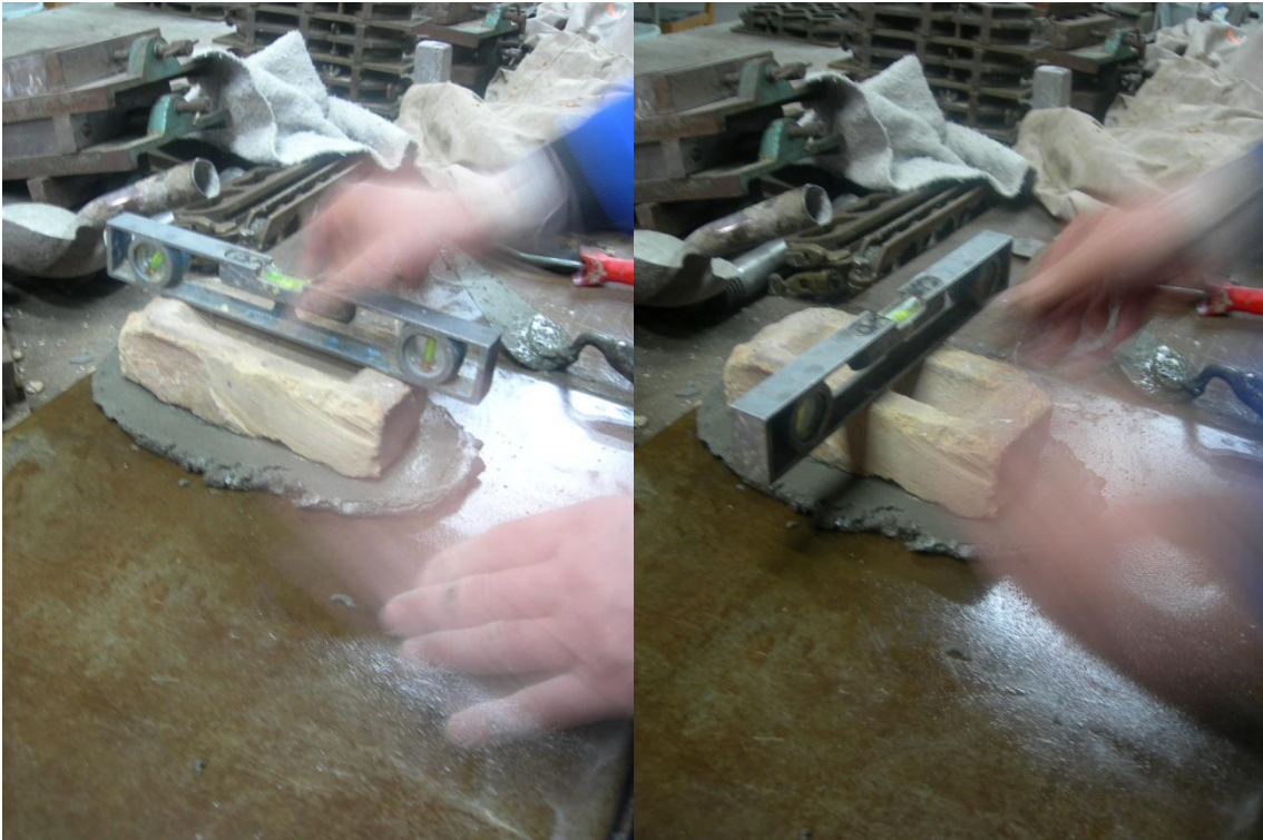
Şekil 310: Başlıkların düzgünlüğünün su terazisiyle kontrol edilmesi
