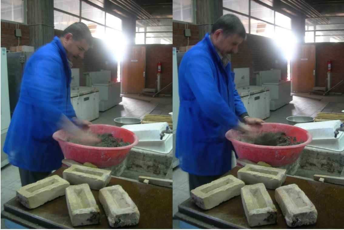
Şekil 309: Başlık için hazırlanan çimento harcı
