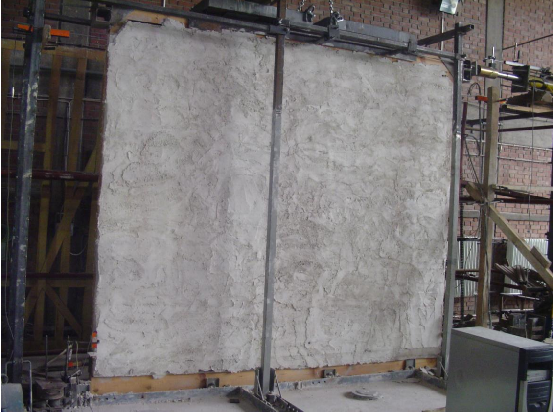
Şekil 185: Şam dolgu örgü ve sıvala işlemlerinin ardından çerçevenin son hali
