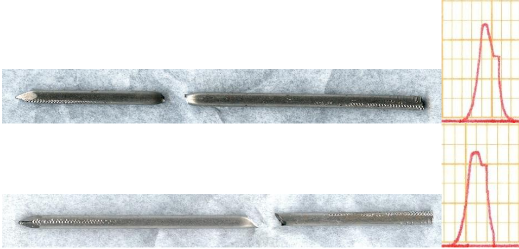
Şekil 304: Çivilerde hem sünek hem de kırılğan davranışta kopma gözlemlenmiştir.
