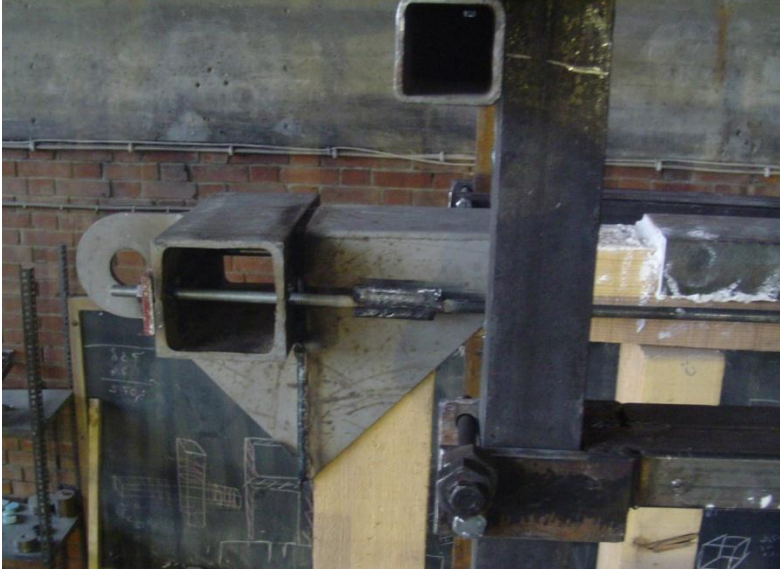
Şekil 9: Manşonların takılı olduğu köşe elemanlar
