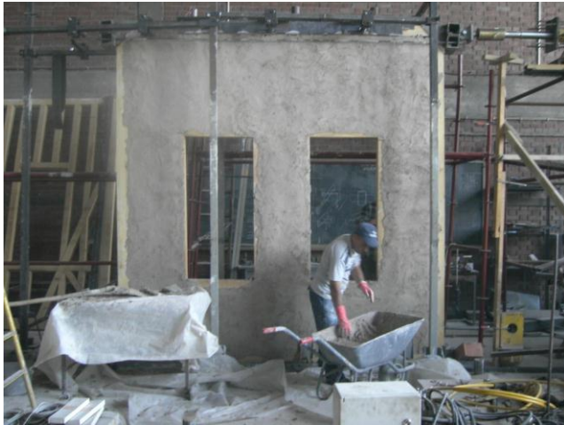
Şekil 204: Çerçevenin tuğla örgü ile doldurulup sıvandığından sonraki son hali
