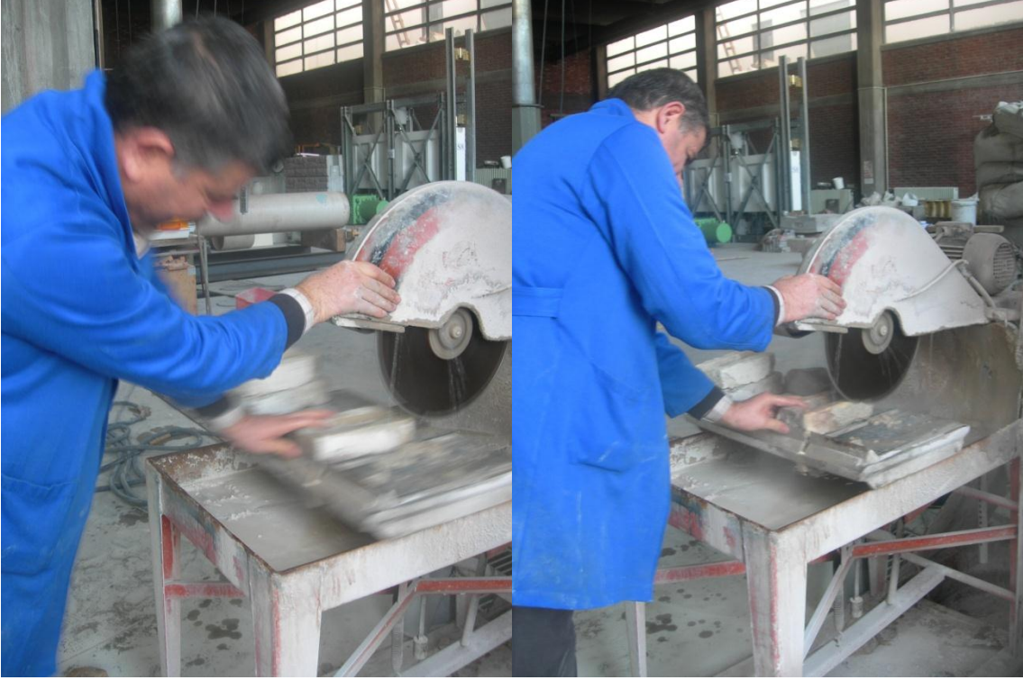
Şekil 308: Kerpiç ve tuğla numunelerin kenarlarının kesilerek düzeltilmesi
