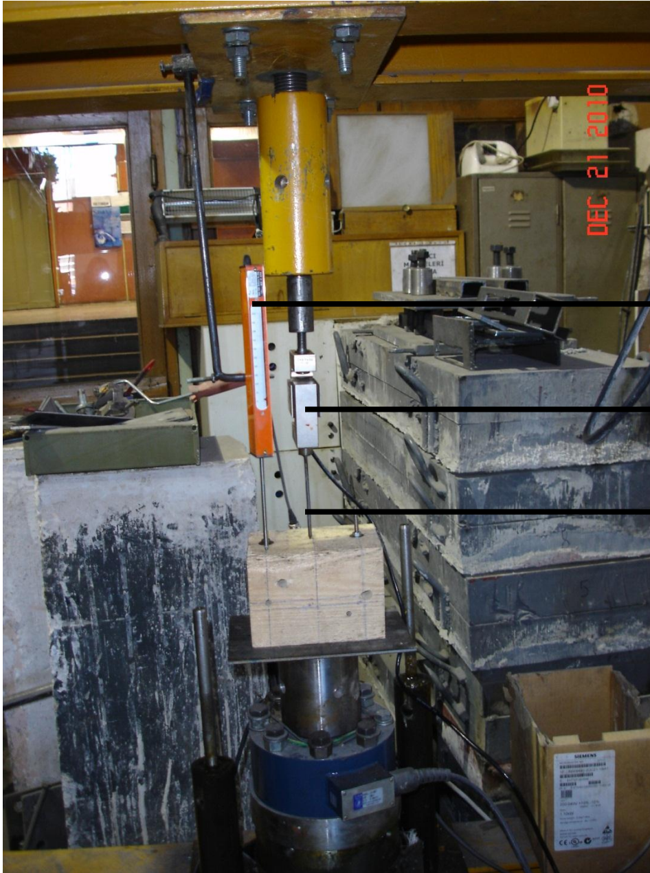
Şekil 317: Çiviye uygulanan itme çekme testi için oluşturulan deney düzeneği
