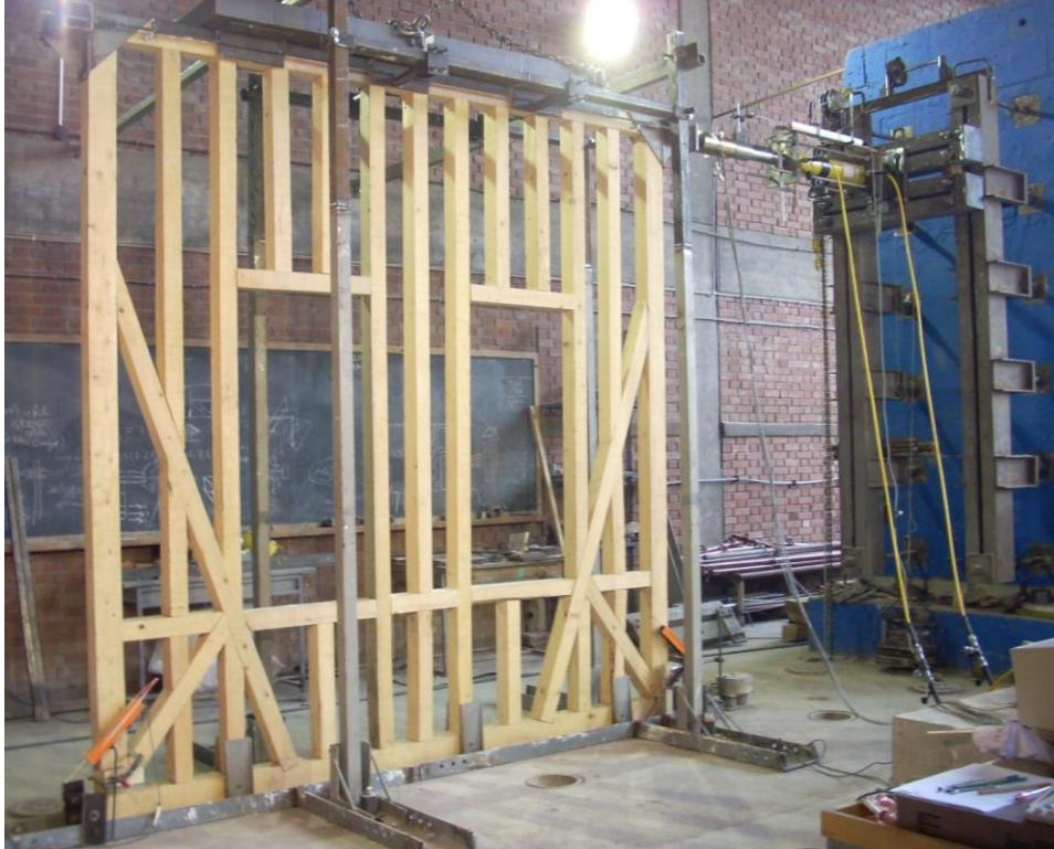
Şekil 16: Test edilen ilk çerçeve ve deney düzeneği
