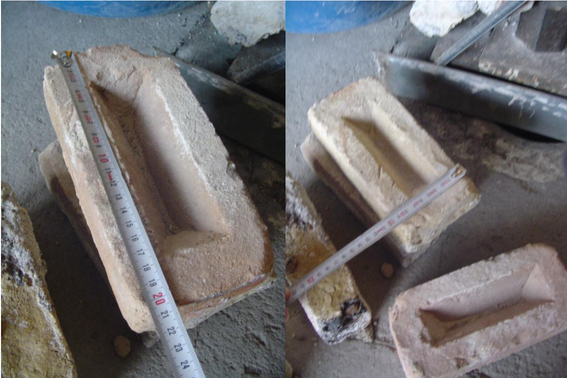
Şekil 263: 21 cm 10 cm boyutlarında içi dolu tuğla
