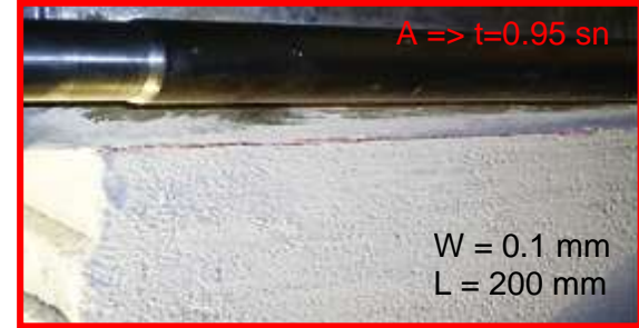
Şekil 87. OBE Depremi Esnasında Oluşan Çatlaklar
