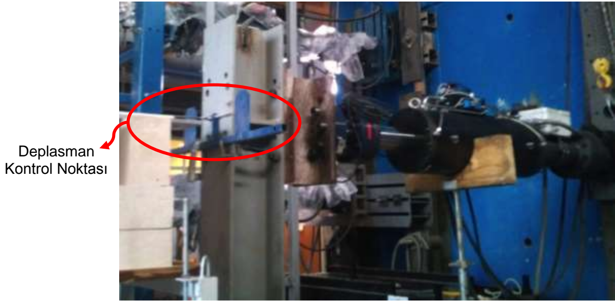
Şekil 41. Deplasman Kontrol Noktası (Heidenhain)
