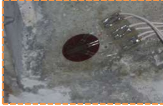
Şekil 53. Baraj Tabanı Birim Uzama Ölçümleri
