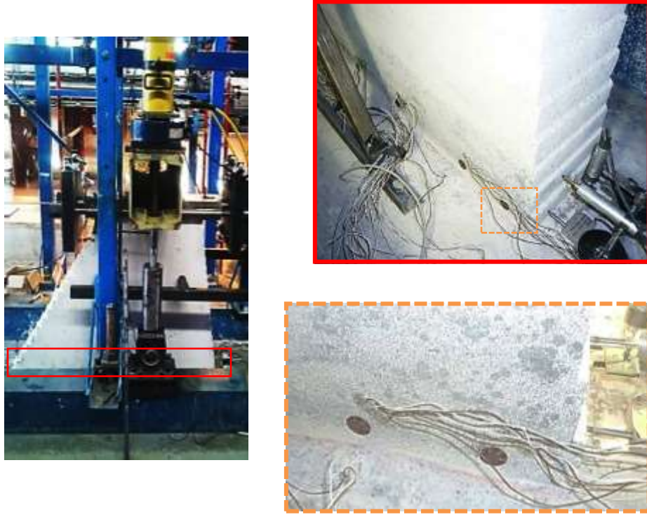
Şekil 81. Baraj Tabanı Birim Uzama Ölçümleri : (a) Barajın Yandan Görünümü ve (b) Beton Rozeti
