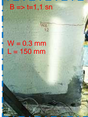
Şekil 125. MCE Depremi Esnasında Oluşan Çatlaklar 1
