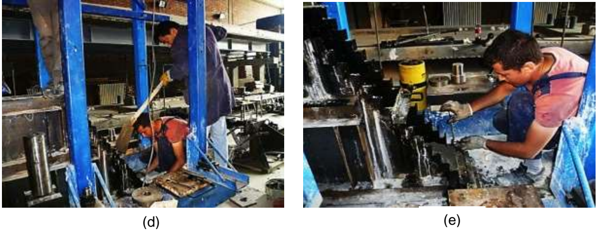
Şekil 77. Beton Dökümü : (a) Çelik Sıkıştırma Aparatı; (b) Plastik Kapla Beton Doldurulması; (c) Kalıptaki Beton; (d) Betonun Küreklerle Yerleştirilmesi ve (e) Kalıp Montajı
