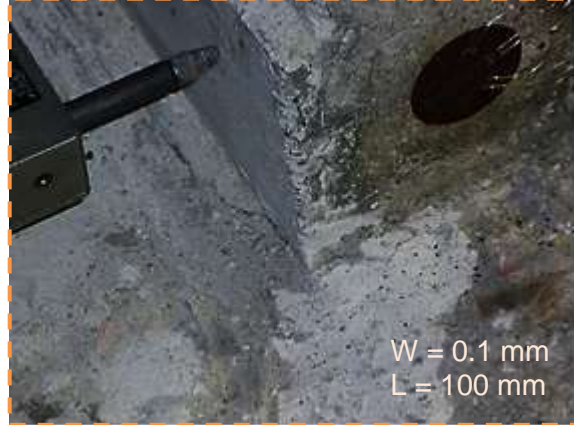
Şekil 55. Hidrostatik Yükleme sonrası Oluşan Çatlaklar
