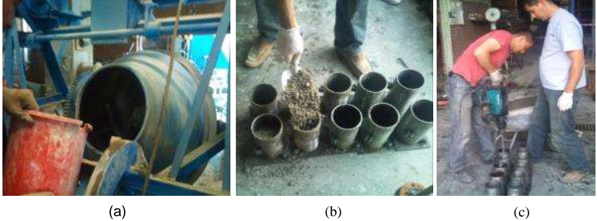
Şekil 10. SSB Döküm Aşamaları: (a) Beton Mikserindeki Karışım; (b) Silindir Kalıpların Doldurulması ve (c) Kompaksiyon
