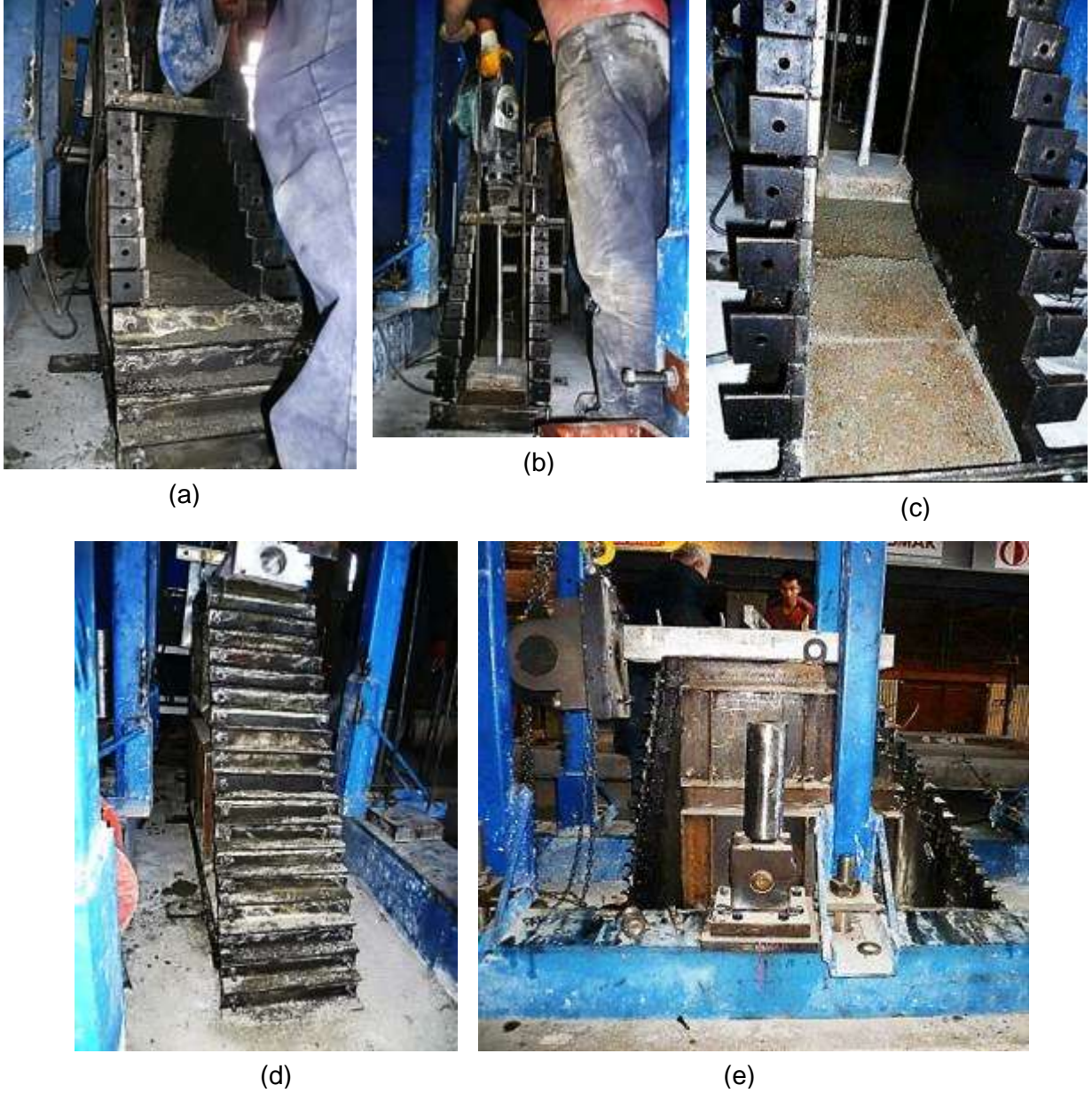
Şekil 106. Beton Dökümü : (a) Kalıba Beton Yerleşmesi; (b) Betonun Sıkıştırılması; (c) Sıkıştırılmış Beton Tabakası; (d) Kapatılmış Kalıp ve (e) Kalıbın Yandan Görünümü
