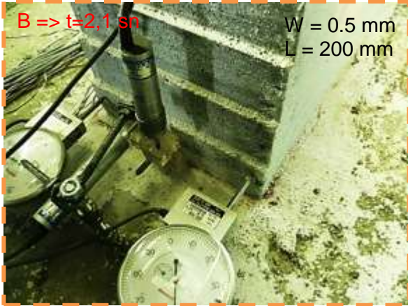
Şekil 119. MDE Depremi Esnasında Oluşan Çatlaklar
