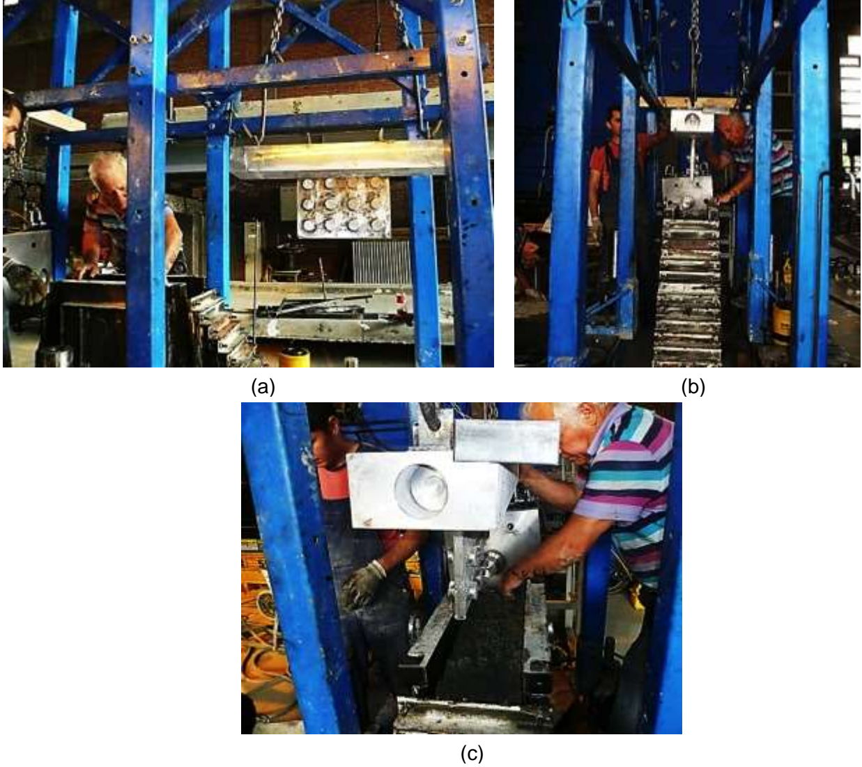
Şekil 78. Yükleme Aparatının Yerleştirilmesi : (a) Yükleme Aparatının Vinçle Taşınması; (b) Yükleme Aparatının Hizalanması ve (c) Yükleme Aparatının Betonun İçine Oturtulması
