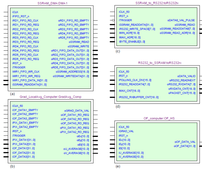
Şekil 96: FPGA temelli Optik Akış tasarımı fonksiyonel donanım modülleri ve giriş/çıkış bağlantıları
