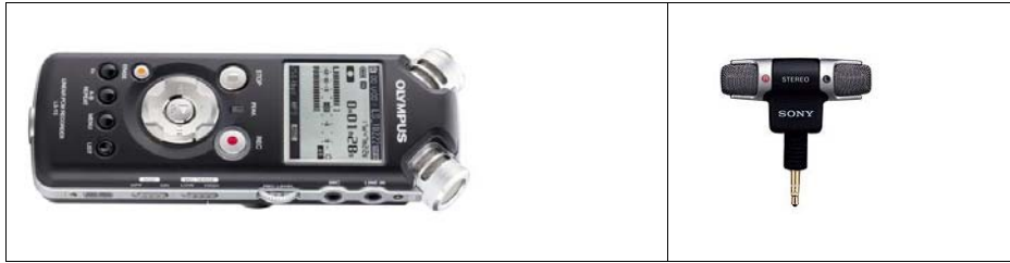
Şekil 103: (a) Olympus LS-10 Doğrusal PCM kayıt cihazı. Bu cihaz 44100 örnek/saniye hızında 24 bit çözünürlük ile kayıt yapabilmektedir. (b) Sony ECM-DS70P mikrofonu.
