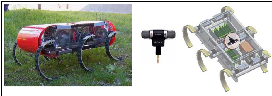
Şekil 104: (a) 106E089 no'lu Tübitak 1001 projesi kapsamında geliştirilen SensorHex bacaklı robot platformumuzun çimen yüzeyi üzerindeki görüntüsü (b) Platform üzerinde mikrofon yerleşimi.
