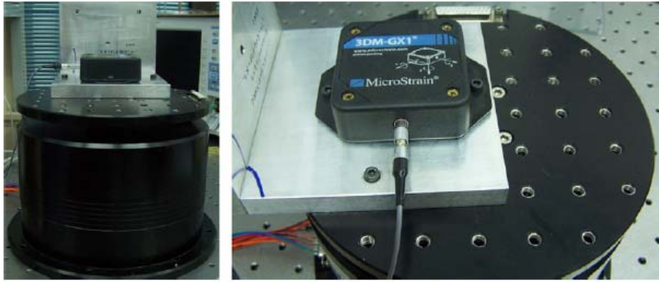
Şekil 141: "Rate Transfer Test": Belli bir ekseninde gerçek dönü miktarı ile algılayıcı eksen çıktıkları arasındaki ilişkinin kontrollü dönü uygulanması yolu ile bulunması.
