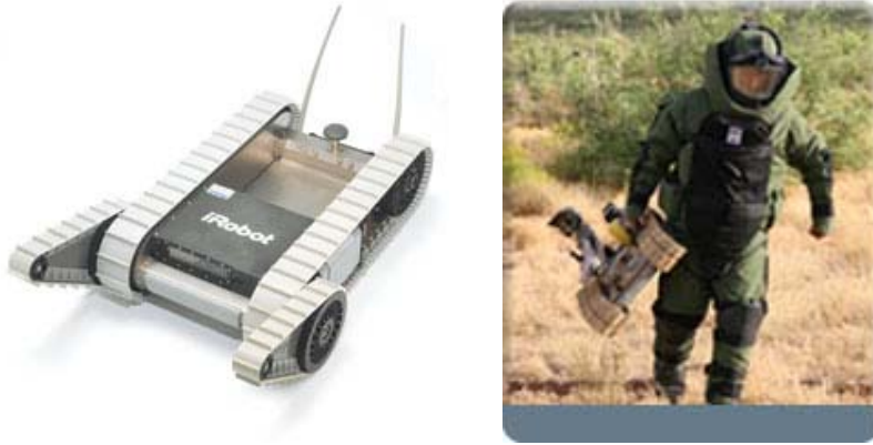
Şekil 2: I-Robot firması tarafından geliştirilen Pack-Bot ve robotun boyutları ile personel tarafından arazi kullanımını gösterir canlandırma.
