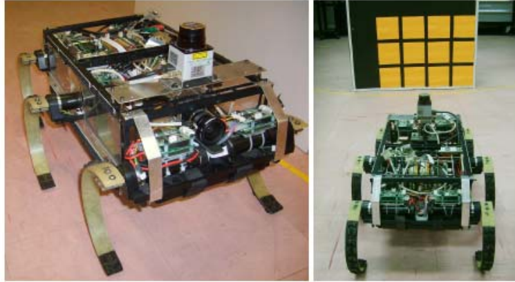
Şekil 120: RoLab bünyesinde kurduğumuz yeni görme temelli durum ölçümü sistemi ve SensoRHex robotunun arkadan görünümü. Üstteki çıkıntı lazer tarayıcıya aittir ve kamera ise robotun önünde bulunmaktadır.
