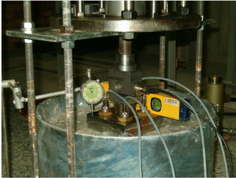
Şekil 3.4 Ölçüm düzeneği ve model kazıklı radye
