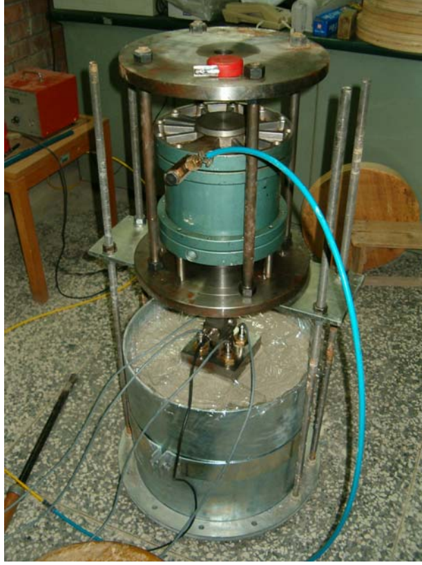
Şekil 3.3 Pnömatik hava silindiri ve yükleme sistemi
