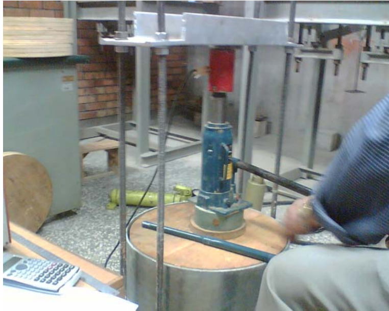
Şekil 3.1 Çelik tanka yerleştirilen zemin karışımının hidrolik kriko kullanılarak sıkıştırılması
