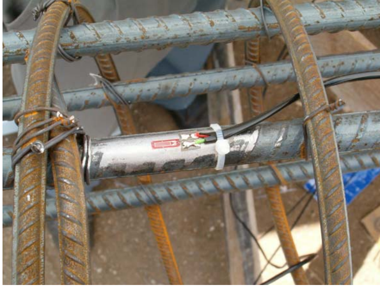
Şekil 2.6 Donatılara yapıştırılan birim deformasyon ölçer
