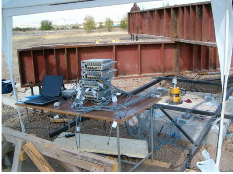
Şekil 2.11 Deney yükleme ve ölçüm sistemi
