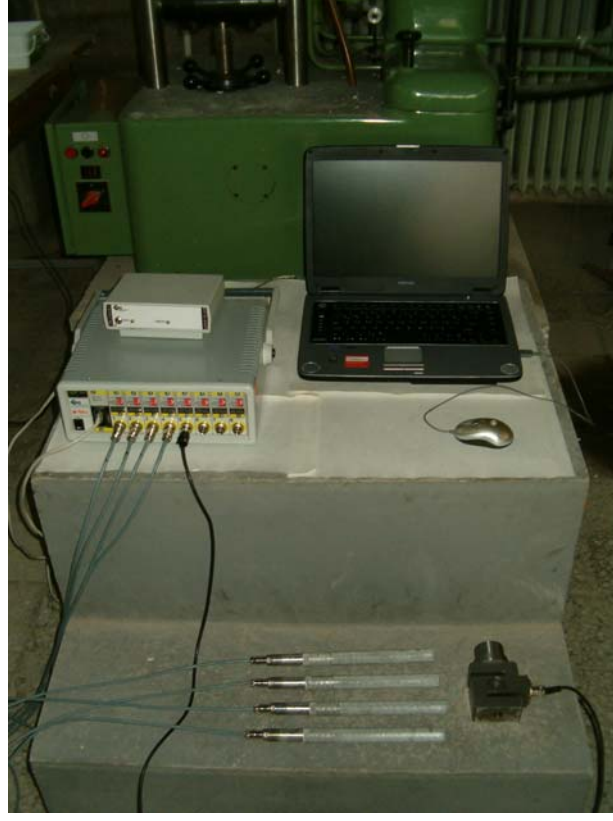
Şekil 3.5 Veri toplama sistemi, model kazıklar ve yük hücresi
