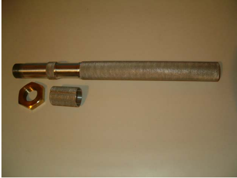
Şekil 3.2 Model kazık, alüminyum kaplama plakası ve sabitleme parçası
