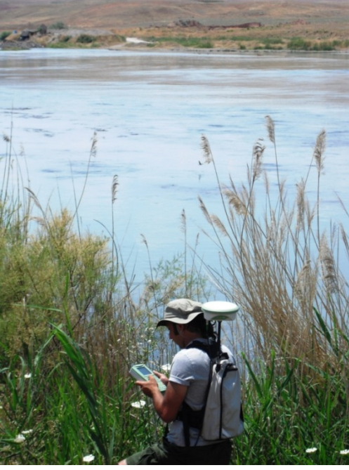
Şekil 20: Kızılırmak Nehri'nin yüksekliğinin GPS ile ölçümü.
