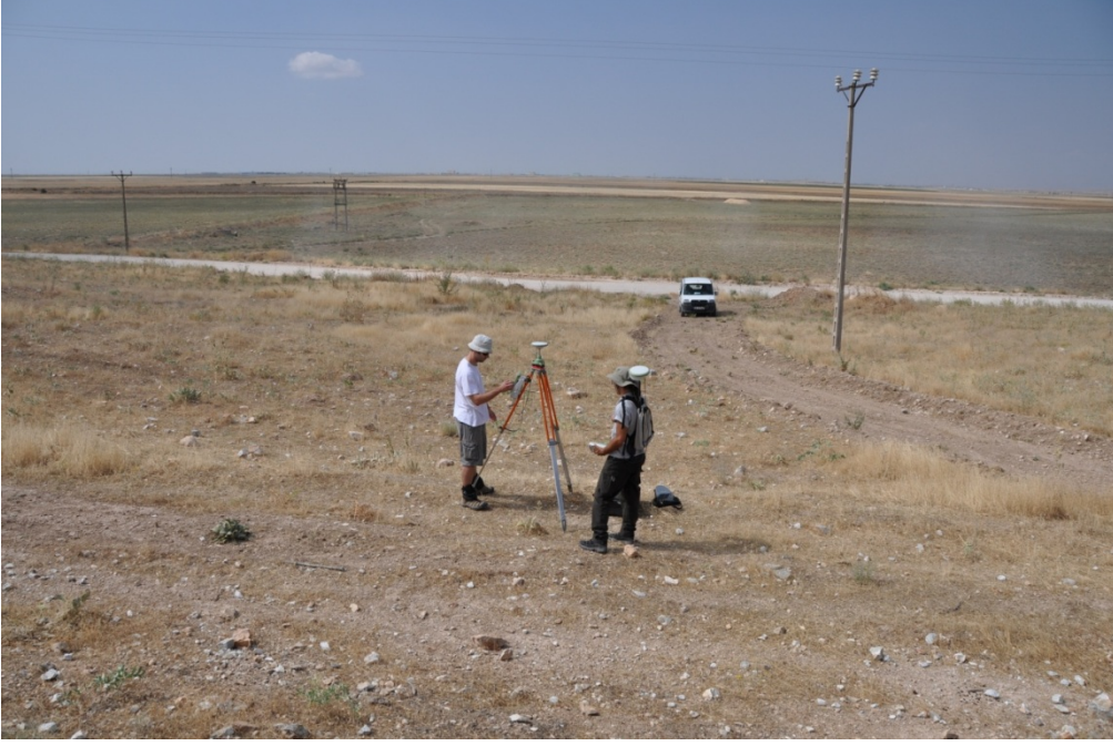
Şekil 45: DGPS sistemi, sabit istasyon ve gezici GPS.
