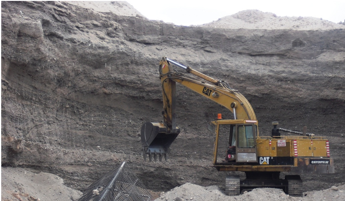
Şekil 26: Çakıl ocağının örnek alımı amacı ile kepçe ile temizlenmesi.
