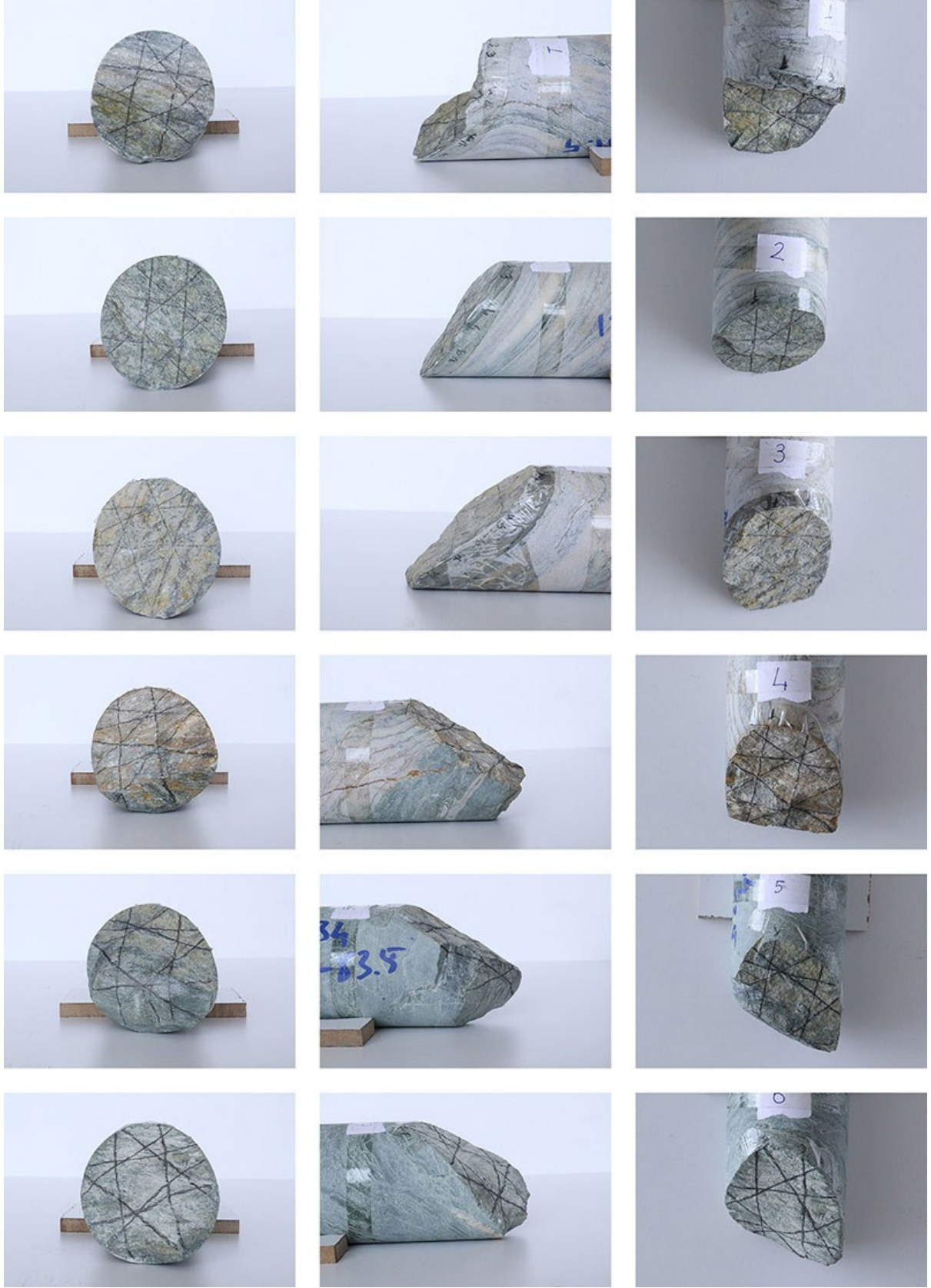
Şekil 50. Çalışmada kullanılan karotlar. Her bir satır farklı bir karot içerir. Sütunlar aynı karotun sırasıyla ön, yan ve üst görüntülerini içermektedir. Yüzeylerden alınan profiller, karotların üzerindeki çizgiler takip edilerek elde edilmiştir.
