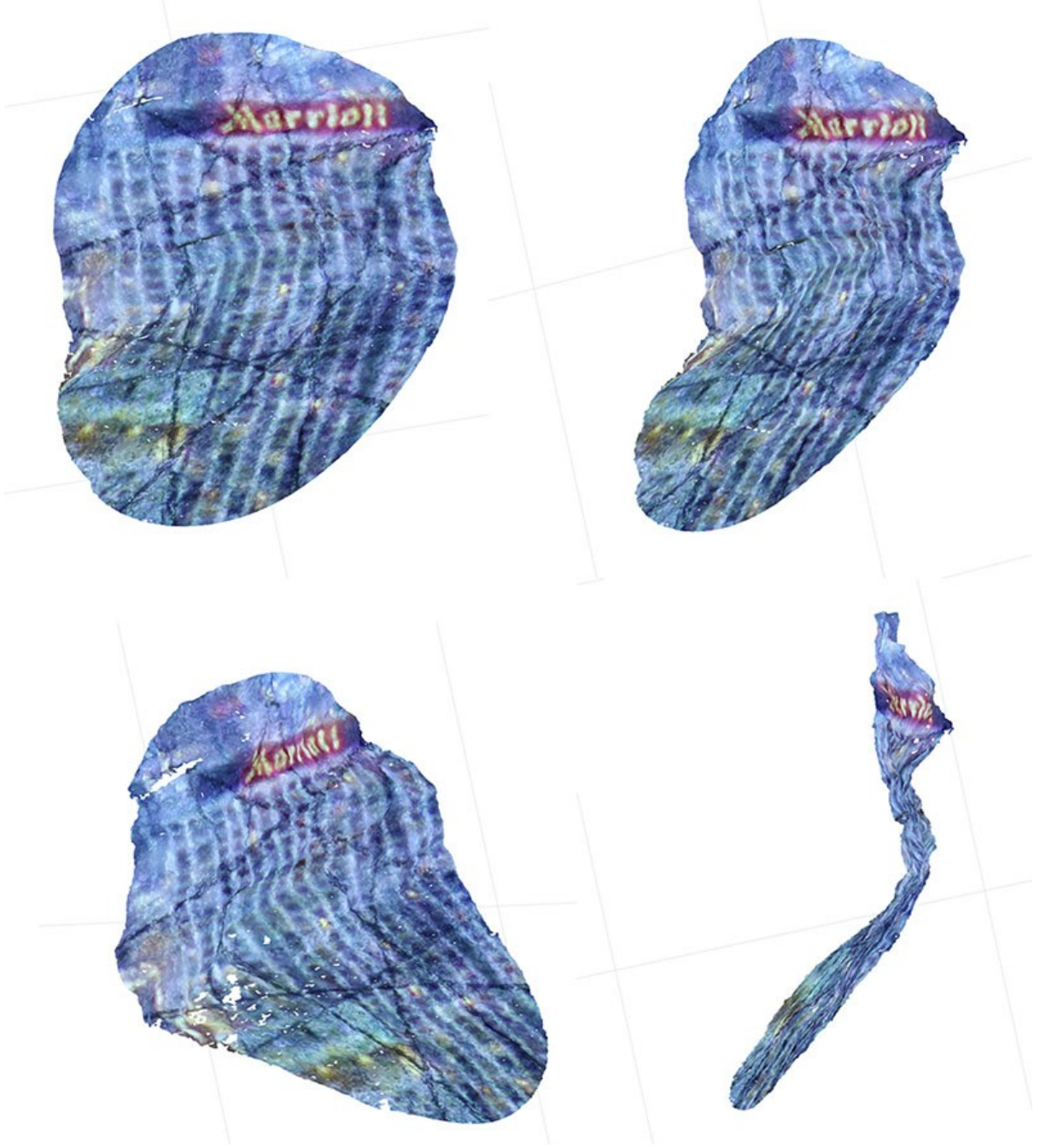
Şekil 90. Üç boyutlu nokta bulutundan yeniden yapılandırılmış karot yüzeyinin farklı açılardan görüntüleri
