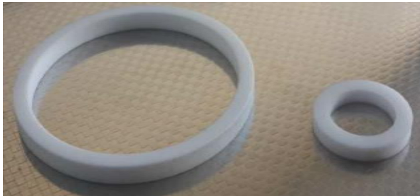
Şekil 3- 1 Deforme edilebilir kalıp olarak kullanılan PTFE halkalar. Sağda ön çalışmalar için kullanılan küçük kalıp, solda ise 2 inç çapında hedef diski üretiminde kullanılan büyük kalıp gösterilmektedir
