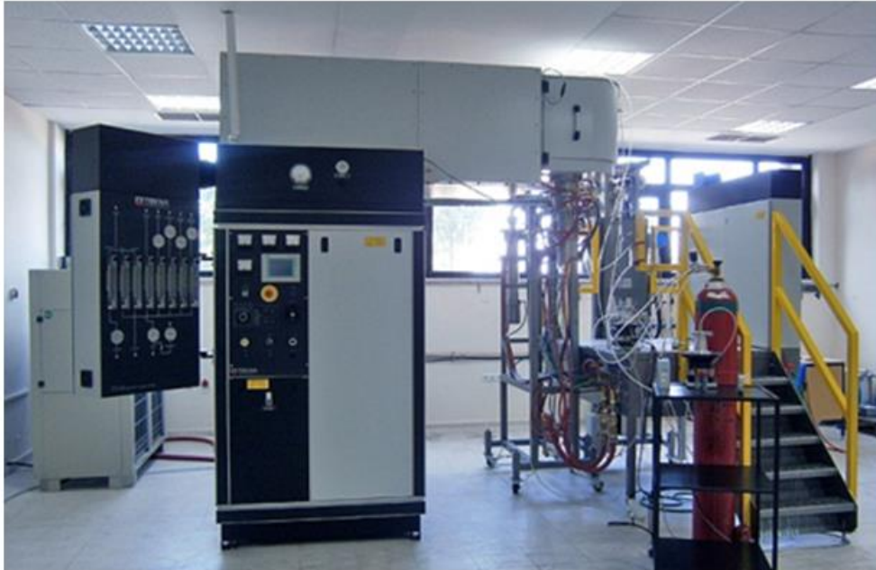
Şekil 6- 1 LSC katod malzemesinin ürettiği termal plazma cihazı
