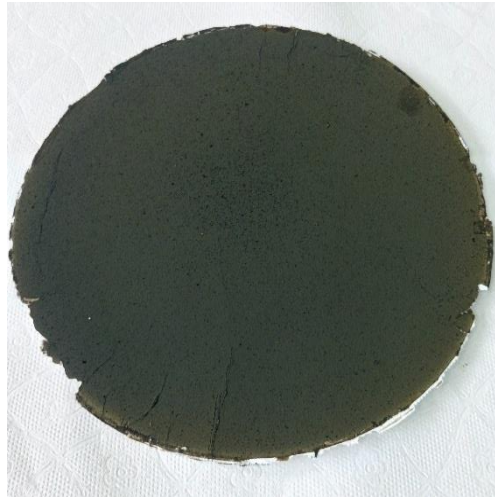
Şekil 6- 2 Toz toplama biriminde filtre üzerinde toplanan LSC tozları
