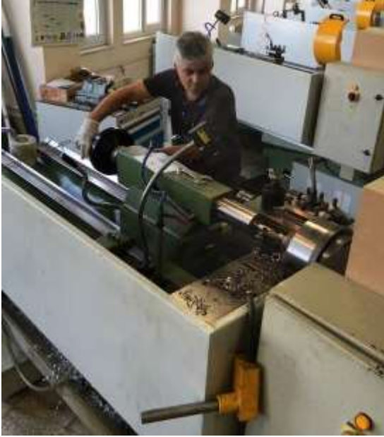
Şekil 89. Torna ve freze tezgâhında kurt ağızlarının açılması
