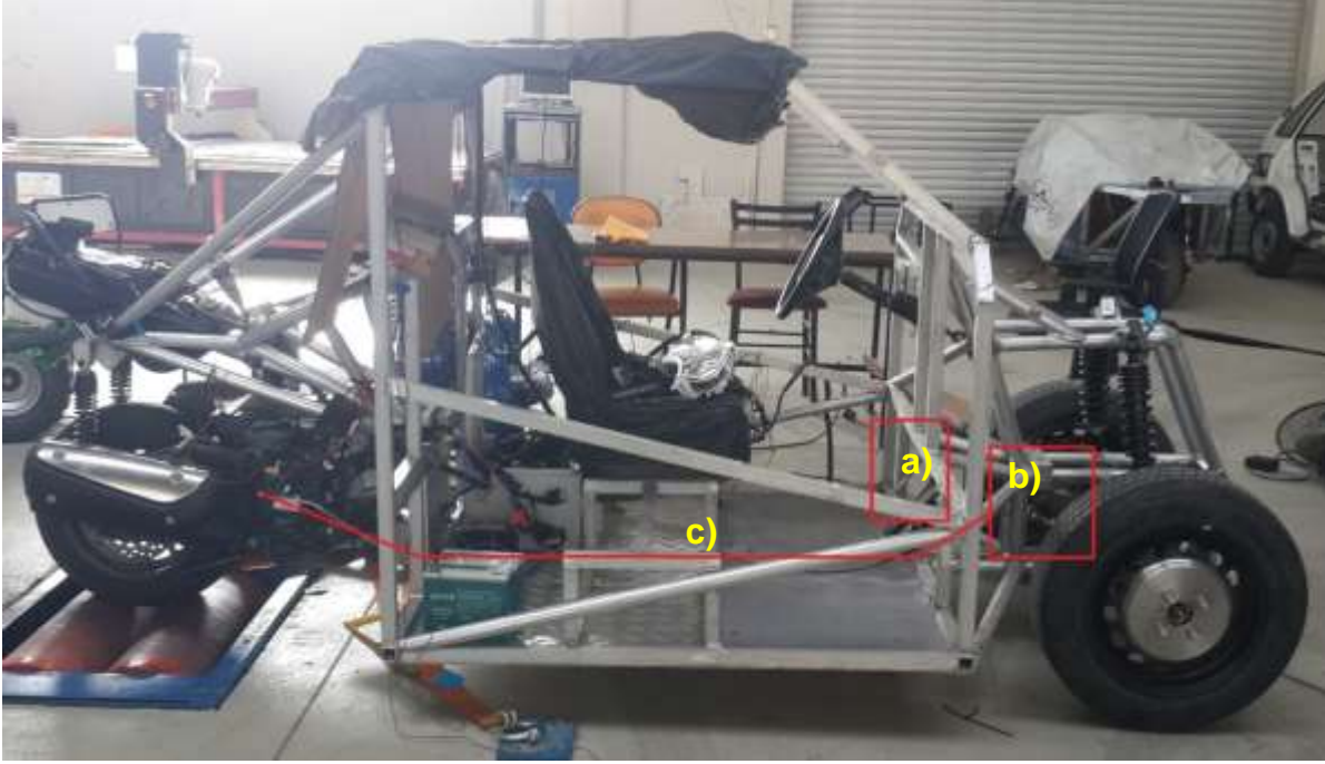
Şekil 98. Kullanılan fren tertibatı a) Fren pedalı b) Fren merkezi (Master Silindir) c) Arka fren hidrolik hattı
