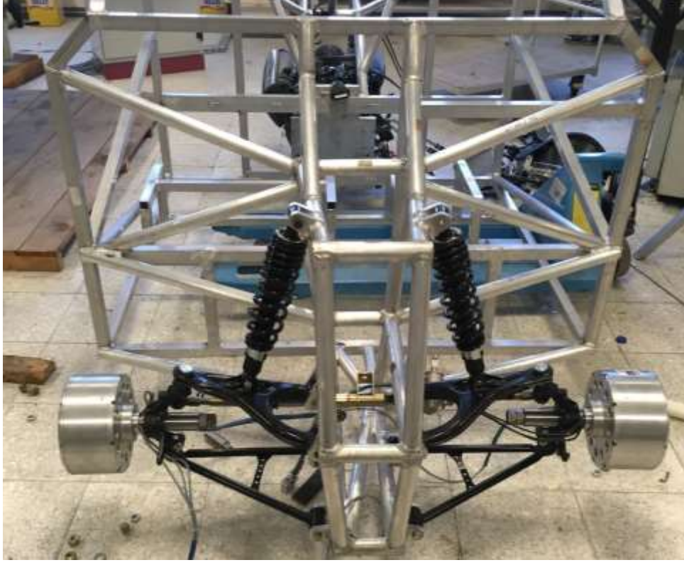
Şekil 95. Süspansiyon sisteminin montajı
