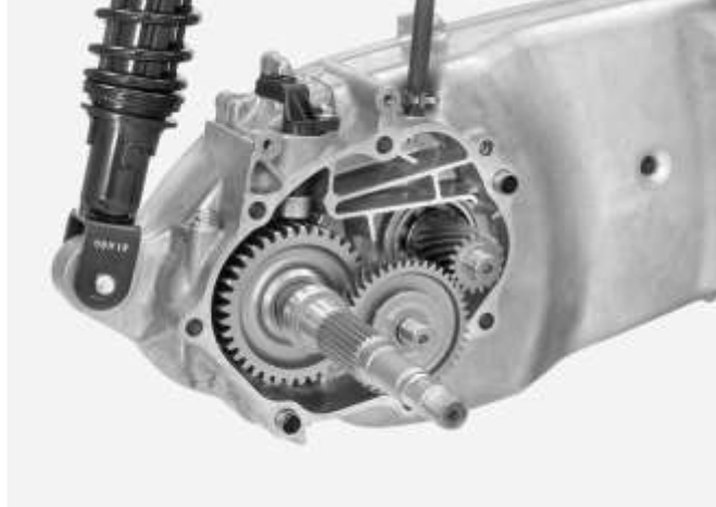
Şekil 125. Varyatör- sabit oran sağlayan kısım
