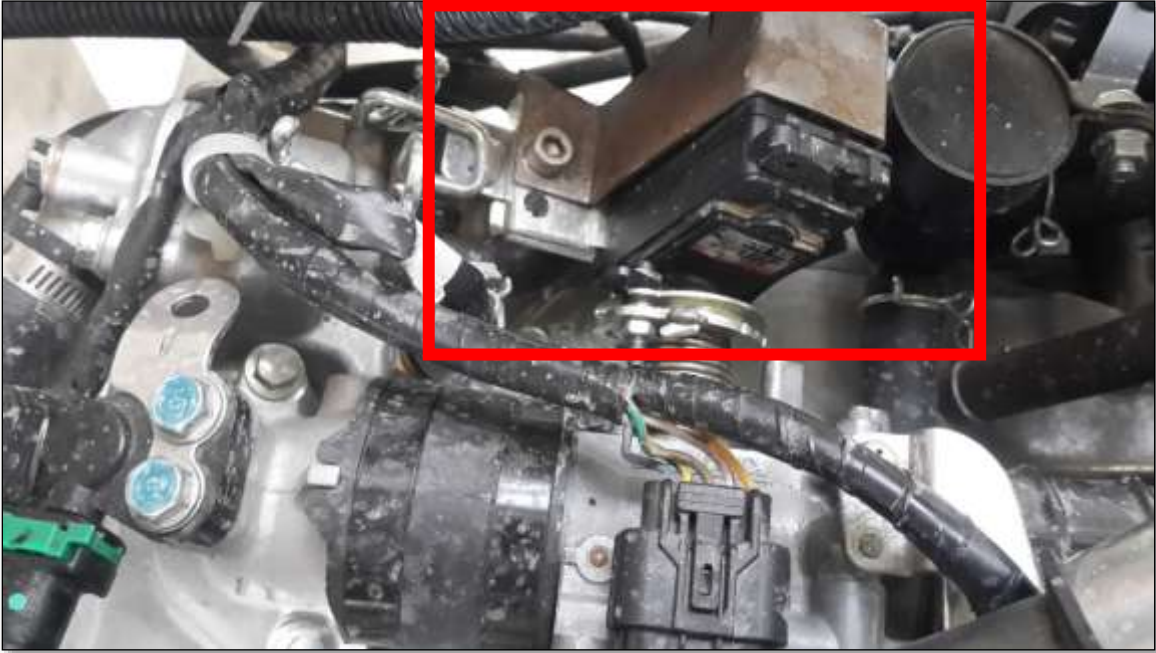
Şekil 103. Gaz Kelebeğine servo motor entegrasyonu
