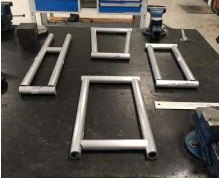
Şekil 90. İşlenen kurtağızlı profil örnekleri
