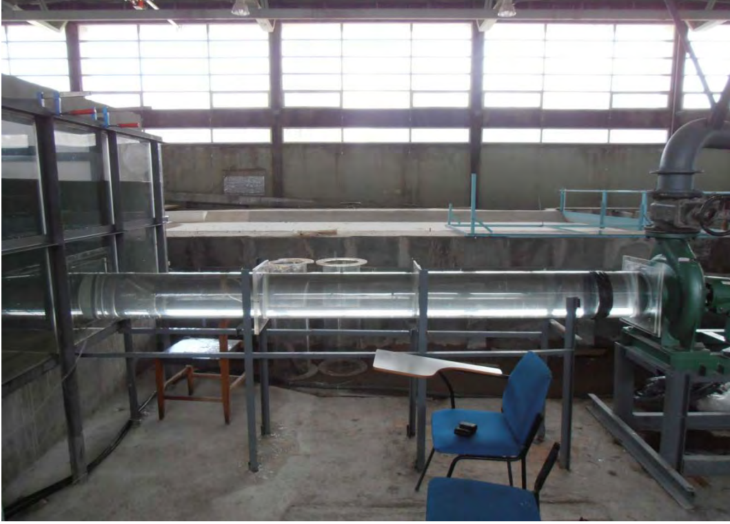
Şekil 3.4 25 cm çapındaki borunun bağlı olduğu deney düzeneği
