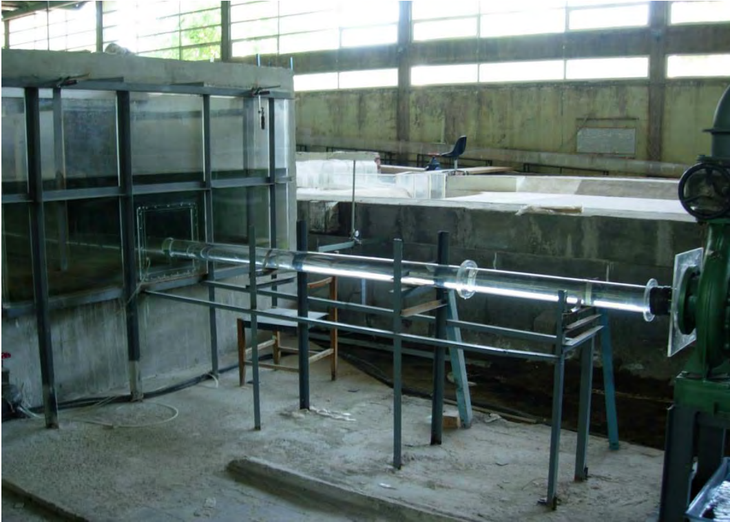
Şekil 3.7 10 cm çapındaki borunun bağlı olduğu deney düzeneği
