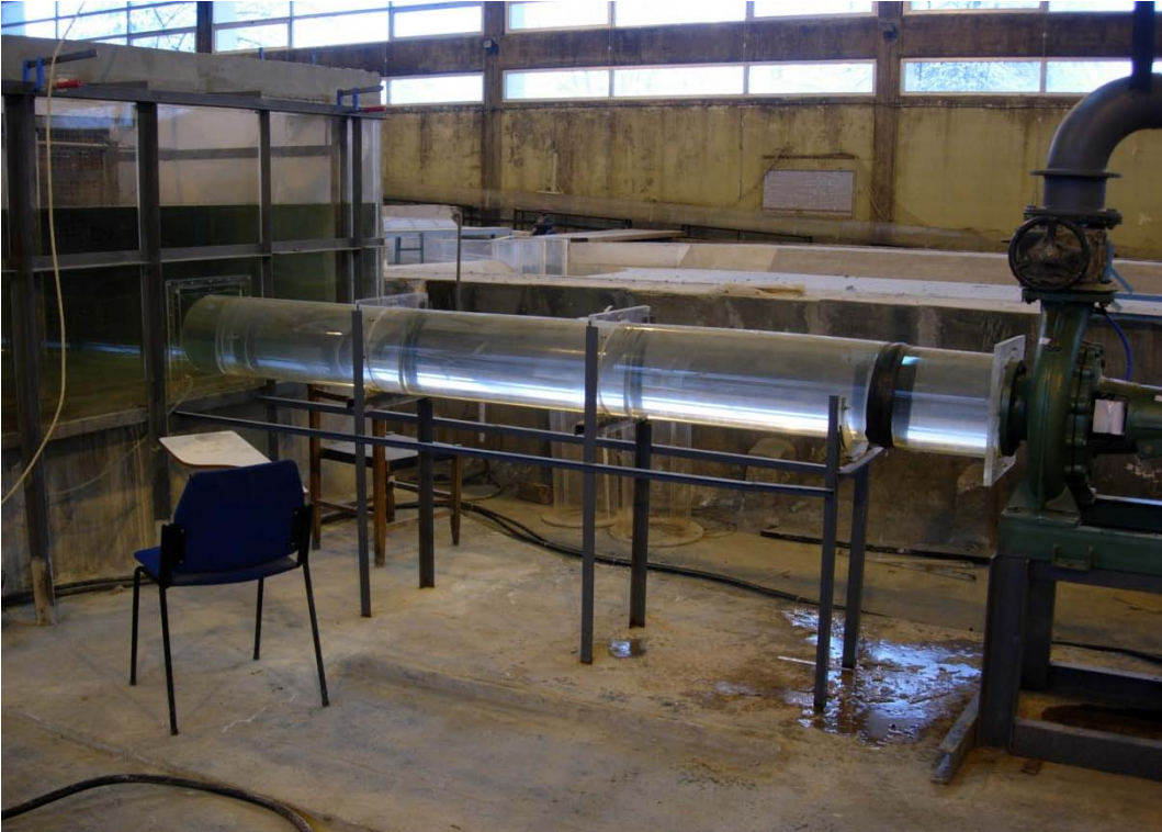
Şekil 3.3 30 cm çapındaki borunun bađlı olduđu deneý düzeneđi
