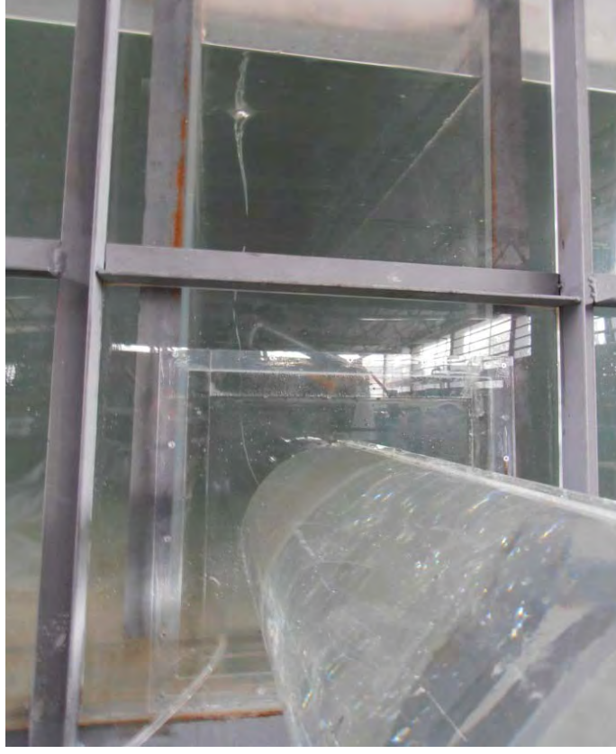
Şekil 3.13 25 cm çapındaki boru üzerinde yapılan deneyler sırasında çekilmiş bir girdabın görüntüsü
