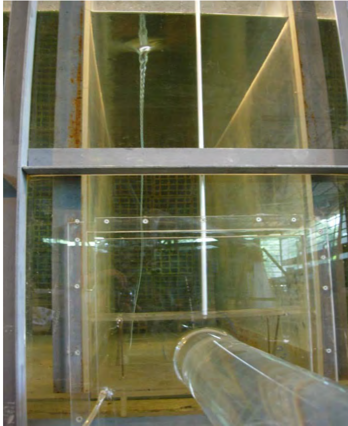
Şekil 3.12 Yüksek bir kritik batıklığa sahip girdabın görüntüsü
