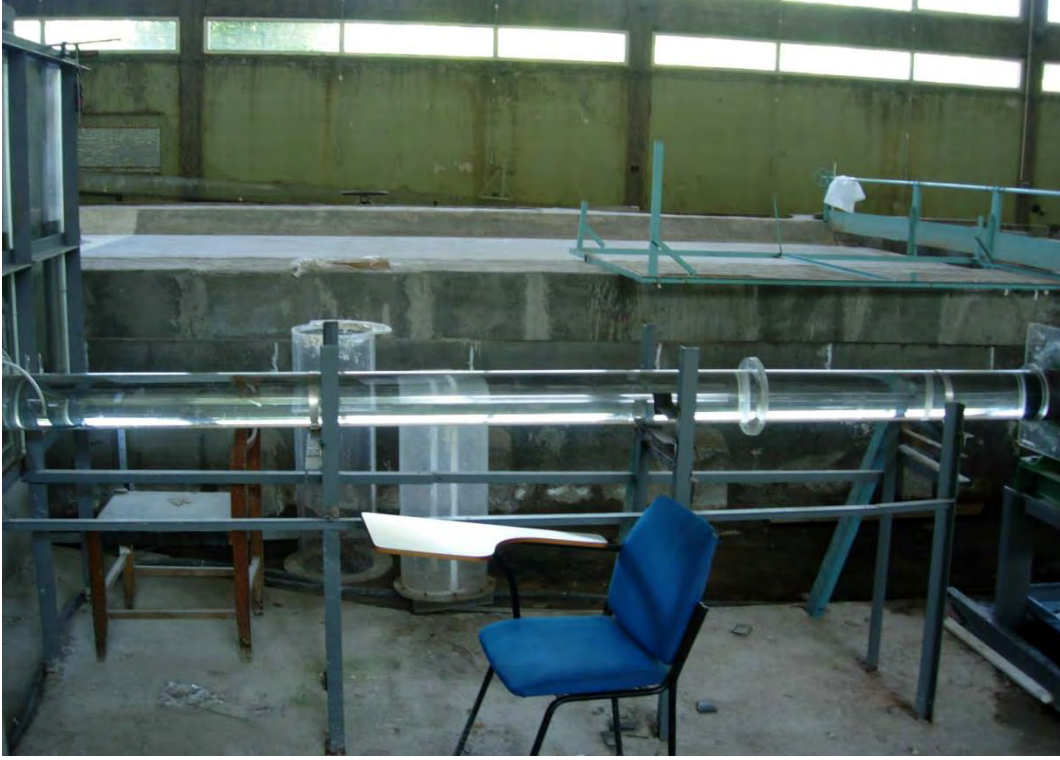
Şekil 3.6 14.4 cm çapındaki borunun bağlı olduğu deney düzeneği
