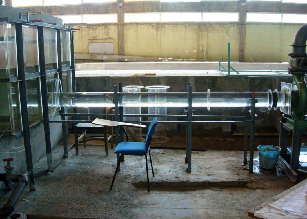
Şekil 3.5 19.4 cm çapındaki borunun bağlı olduğu deney düzeneği
