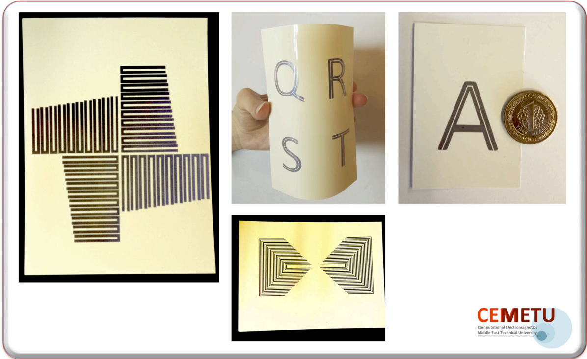
Şekil 31. Proje kapsamında geliştirilmiş olan bazı çipsiz RFID etiketlerinin ucuz inket baskı yöntemiyle üretilmiş prototipleri.
