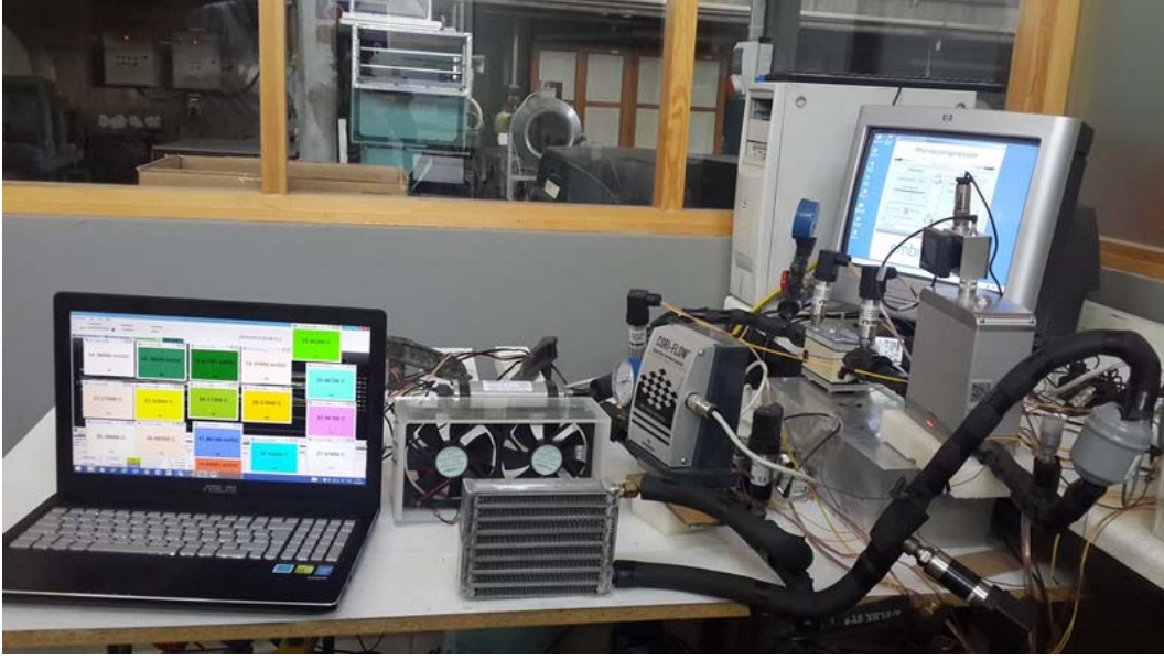
Şekil 22. Deney düzeneği fotoğrafı – üretilmiş kondenser ile
