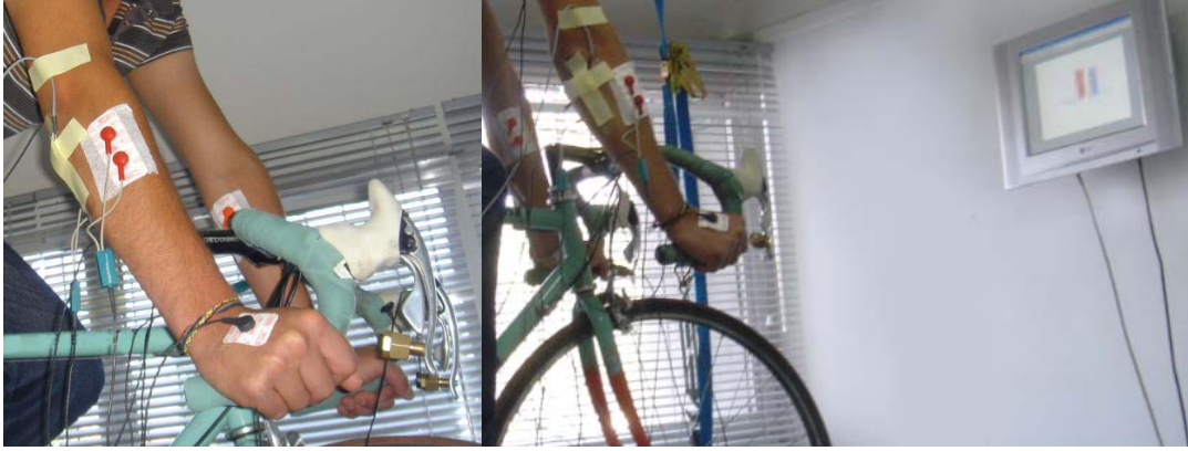
Şekil 7. Elektrot yerleşimi ve kuvvet çıktısı geri bildirim düzeneği
