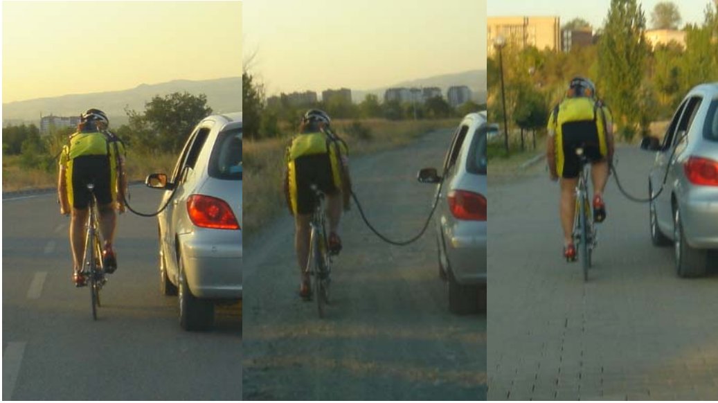
Şekil 4. Ölçüm yapılan yüzeyler (solda: asfalt yol, ortada: toprak yol, sağda: beton parke yol ) ve sürücü-kayıt aracı bağlantısı
