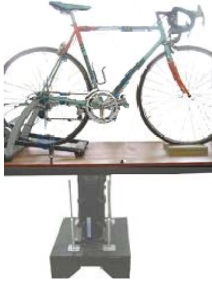
Şekil 2. Elektronik sarsıcı, platform ve test bisikleti yerleşimi
