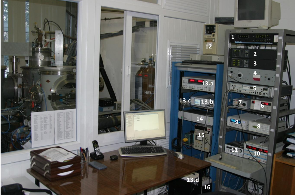
Şekil 6 HAK sisteminin kontrol elektroniği bileşenleri. SMD odacığı (1) helyum demeti odacığı (2) ve kırım odacığı (3) basınç göstergeleri. (4) Helyum demet biçici kontrolcüsü, (5) Eşzamanlı Amplifikatör (EA) helyum kırım sinyali için, (6) Sıcaklık monitörü, (7) SMD biçici kontrolcüsü, (8) Örnek sıcaklık kontrolcüsü, (9) helyum demeti kaynağı sıcaklık kontrolcüsü, (10) SMD kaynağı ısıtıcısı, (11) Inficon çökeltme monitörü kontrolcüsü, (12) Örnek gonyometre motor kontrolcüsü, (13) KKMT sürücü devresi elemanları [(a) Eşzamanlı Amplifikatör (EA), (b) frekans sentezleyici, (c) amplifier/rectifier, (d) veri toplama kartı], (14) KS kontrolcüsü, (15) Argon saçtırma tabancası kontrolcüsü, (16) Tüm sistemi kontrol eden bilgisayar.
