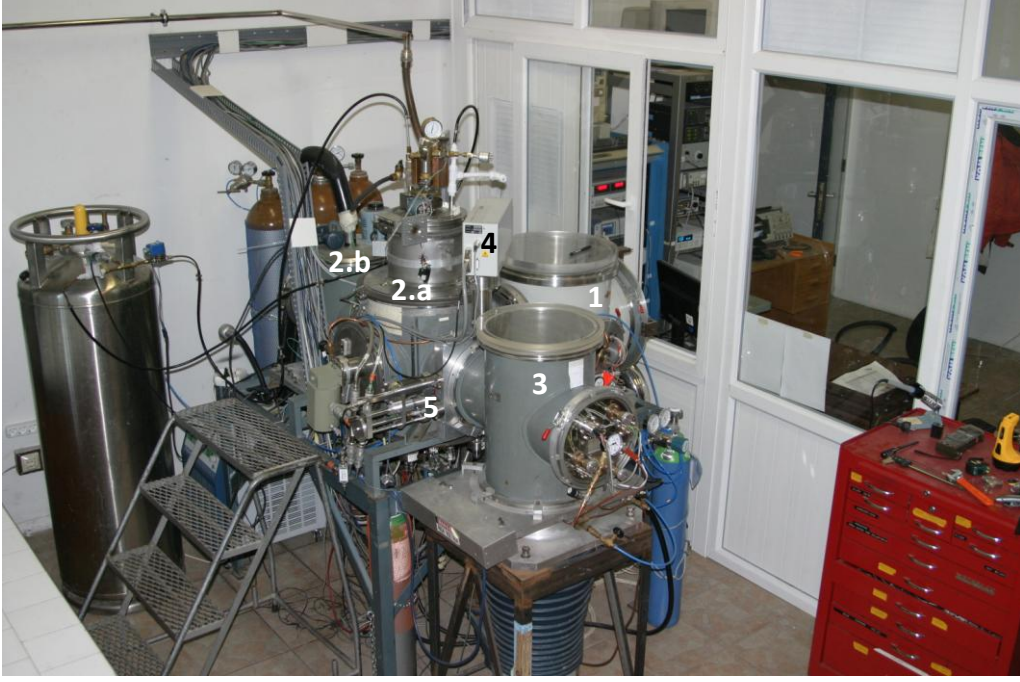
Şekil 5 HAK sisteminin (Deney odası) Ocak 2011 tarihli görüntüsü. (1): 1 numaralı vakum odacığı, (2): 2 numaralı vakum odacığı (a: saçılma odacığı, b: pompa odacığı), (3): 3 numaralı vakum odacığı, (4) KS, (5) Inficon çökeltme monitörü.
