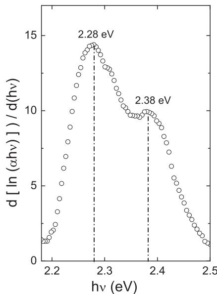
Fig. 4. The dependence of  $d(\ln(\alpha h\nu))/d(h\nu)$  on  $(h\nu)$  for  $\text{Ga}_2\text{SeS}$  crystal.
