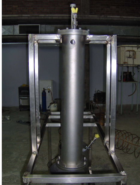
Şekil 5.3 Gövde-borulu adsorban yatağın genel görünüşü
