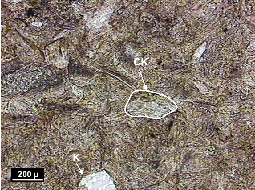
Şekil 4.7 GZ feslik tuf örneği polarizan mikroskop görüntüsü. Kuvars (K) ve zeolitleşmiş cam kıymığı (CK).
