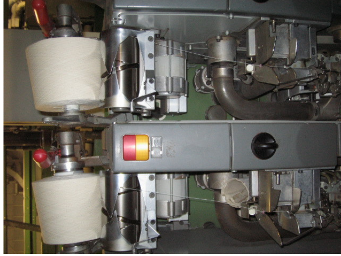
Şekil 15. Kopslardan Büyük Bobin Sarma İşlemi
