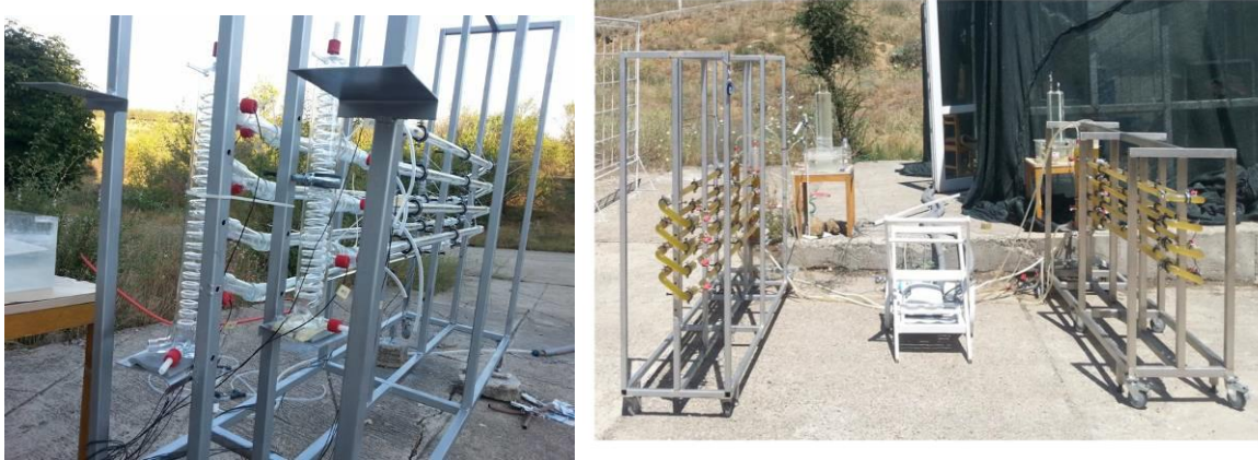
Şekil 6.1. Kurulan 9-11 litrelik reaktörler. Solda: Boş 11 litrelik reaktör, sağda: reaktörler çalışırken.
