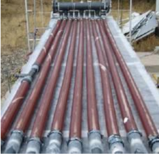
Şekil 2.1 Önceki çalışmalarda (Boran, 2011) kullanılan fotobiyoreaktör.
