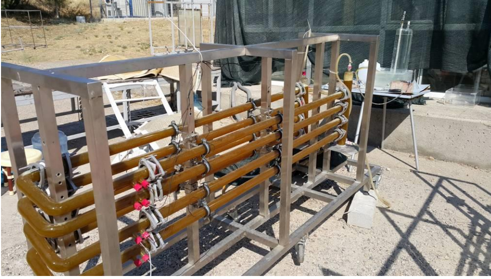
Şekil 6.2 Kurulan 20 litrelik reaktör (çalışırken)
