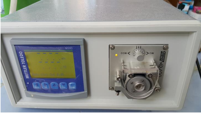
Şekil 8.1 pH kontrol sistemi. Solda, pH ölçüm cihazı, sağda, peristaltik pompa.
