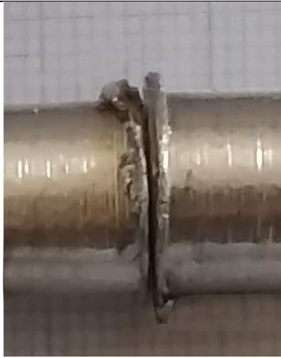
Gambar 12. Flash pada spesimen B45
