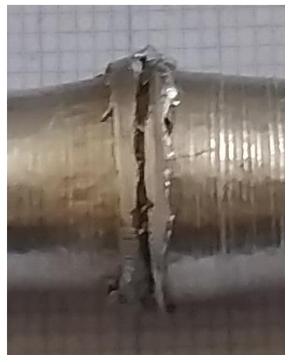
Gambar 11. Flash pada spesimen B45
