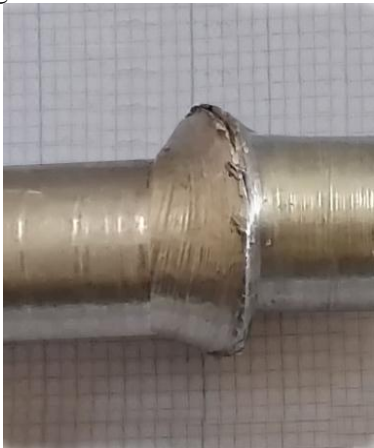
Gambar 8 Flash pada sepsimen A45
