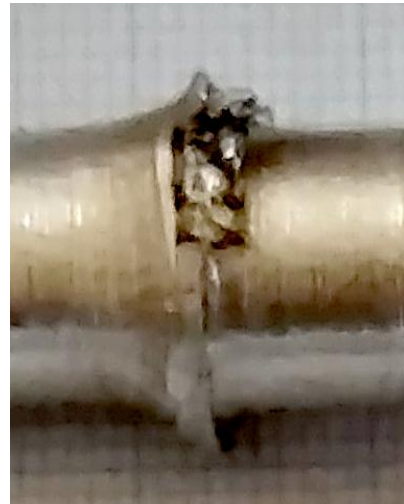
Gambar 10. Flash pada sepsimen B30
