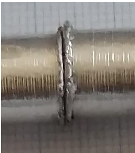
Gambar 9. Flash pada spesimen A60
