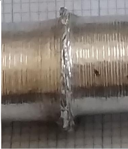
Gambar 7. Flash pada sepsimen A30
