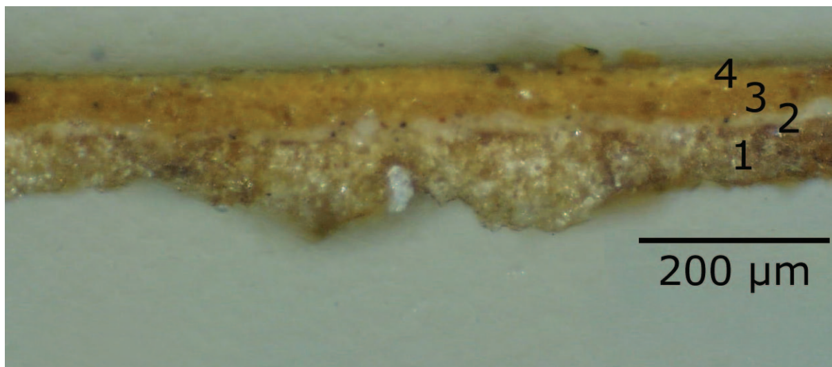
Figura 10 – Corte estratigráfico da amostra recolhida na zona do brocado amarelo de Zacarias, junto manto verde (ampliação de 100×).
