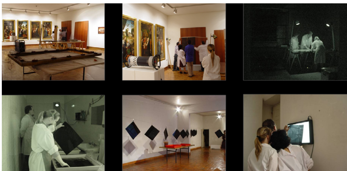
Figura 2 - Processo de radiografia in situ ; câmara escura para o processo de revelação; visualização das películas/resultados, após a secagem.
