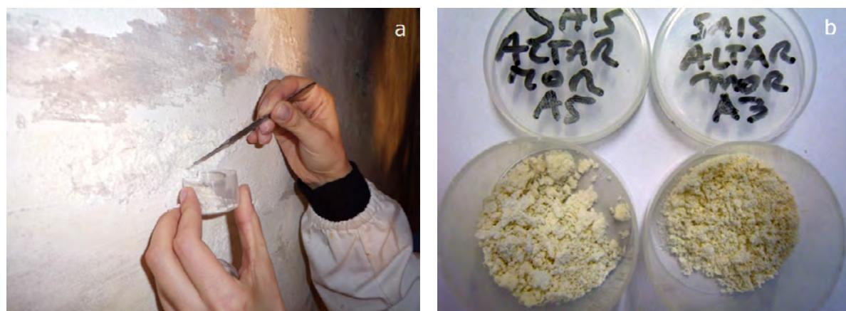
Fig. 17 – Amostras coligidas, das eflorescências salinas.
