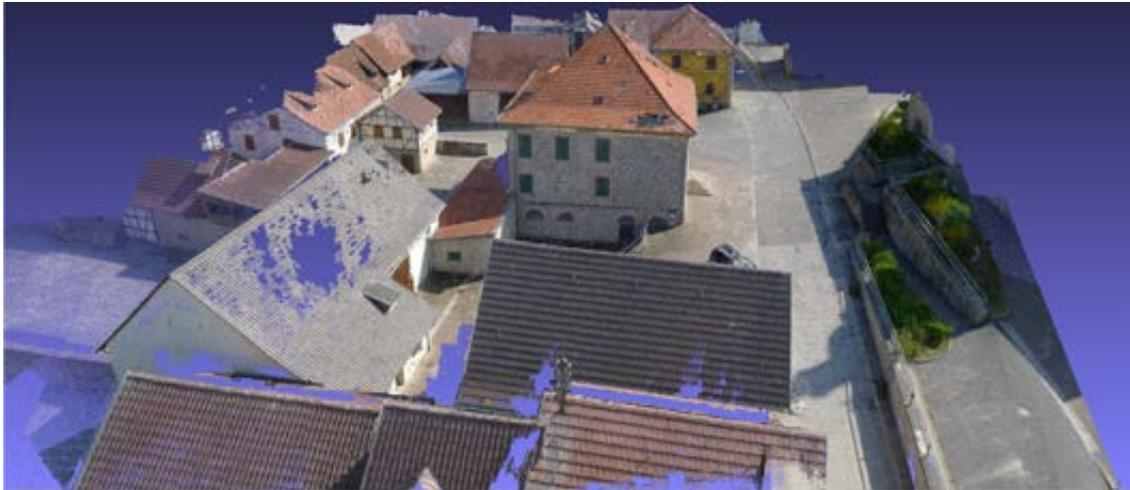
Abbildung 8.3: Dichte 3D Punktwolke – Ergebnis dichte Tiefenschätzung mittels Semiglobal Matching – SGM (Hirschmüller, 2008) auf der Grundlage einer durch FASIAM bestimmten hoch genauen relativen Orientierung.
