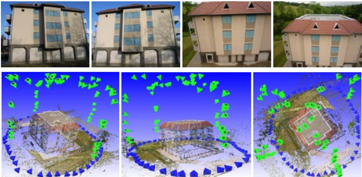
Abbildung 6.32: Haus 51 Bonnland, Kombination von Boden- und Luftaufnahmen mit zwei verschiedenen Kameras (112 Bilder,  $\sigma_0 = 0.26$  Pixel).
