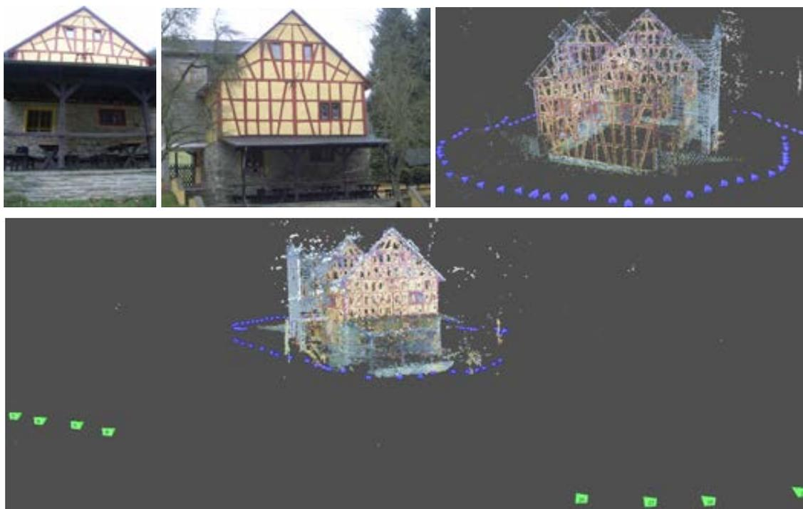
Abbildung 6.21: 3D Rekonstruktion einer Bildsequenz, bei der starke Maßstabsunterschiede auftreten – Bilder (oben links und Mitte) und Visualisierung der 3D Rekonstruktion (oben rechts und unten). 82 Bilder,  $\sigma_0 = 0,33$  Pixel.
