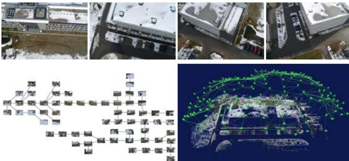
Abbildung 8.2: Ergebnis eines Prototypen zur automatischen Auffindung von Überlappungen für den Drei-Bild-Fall. Oben: Ungeordnete Bilder (Institut für Robotik und Mechatronik, DLR) eines Gebäudes. Unten links: Automatisch generierter Spannbaum. Unten rechts: Ergebnis der relativen Orientierung mit Kennzeichnung der verknüpften Bildpaare.
