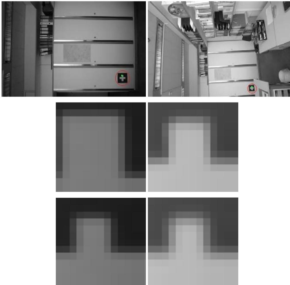
Abbildung 4.4: Anpassung der Bildausschnitte zur Lösung der in Abschnitt 3.5 erläuterten Problematik. Obere Zeile: Bilder mit markierten SIFT-Punkten. Mittlere Zeile:  $13 \times 13$  große Bildausschnitte der Originalauflösung, die offensichtlich verschiedene Inhalte aufweisen. Untere Zeile:  $13 \times 13$  große Bildausschnitte, die mit der in diesem Abschnitt beschriebenen Methode angepasst wurden. Die Inhalte stimmen nahezu überein.
