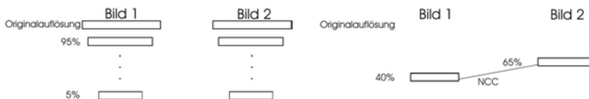
Abbildung 4.1: Links: Vorbereitung eines Bildpaars für die normierte Kreuzkorrelation unter Beachtung der Skalierungsverhältnisse. Rechts: Auswahl der Bildebenen für die normierte Kreuzkorrelation in Abhängigkeit vom Maßstabsraum Extremwert der jeweiligen SIFT-Punkte.
