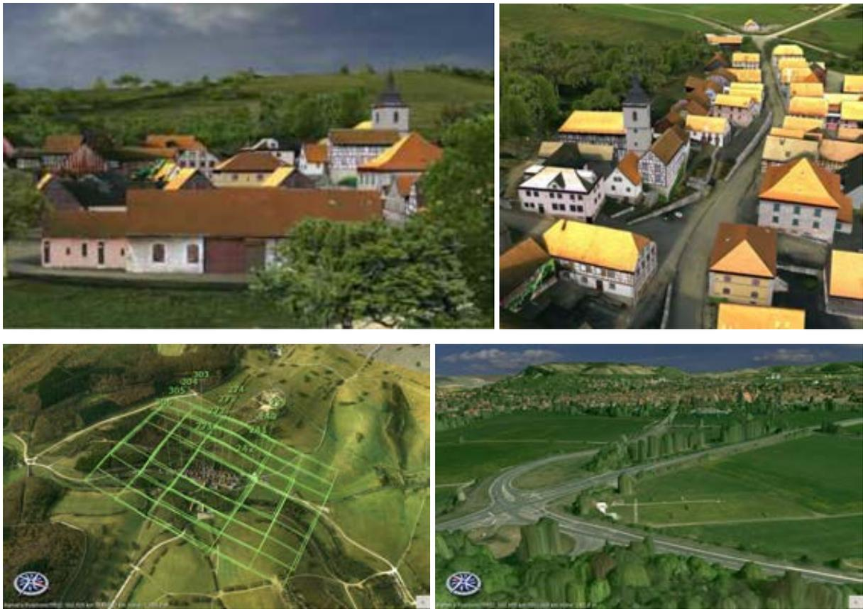
Abbildung 1.3: Links und rechts oben: Übungsdorf Bonnland visualisiert in AGeoBw 3D Welten. Für dieses Resultat wurden ca. 4.300 Bilder einer digitalen Luftbildkamera (Vexcel Ultracam) verwendet. Die Auswertung erfolgte durch ein Hochleistungsrechensystem und nahm 14 Tage Rechendauer in Anspruch. Links unten: Bildüberdeckung für die Modellierung Bonnlands in 3D Welten. Rechts unten: Blick auf die Stadt Hammelburg. Mit freundlicher Unterstützung durch das AGeoBw Dezernat II 2 (2).
