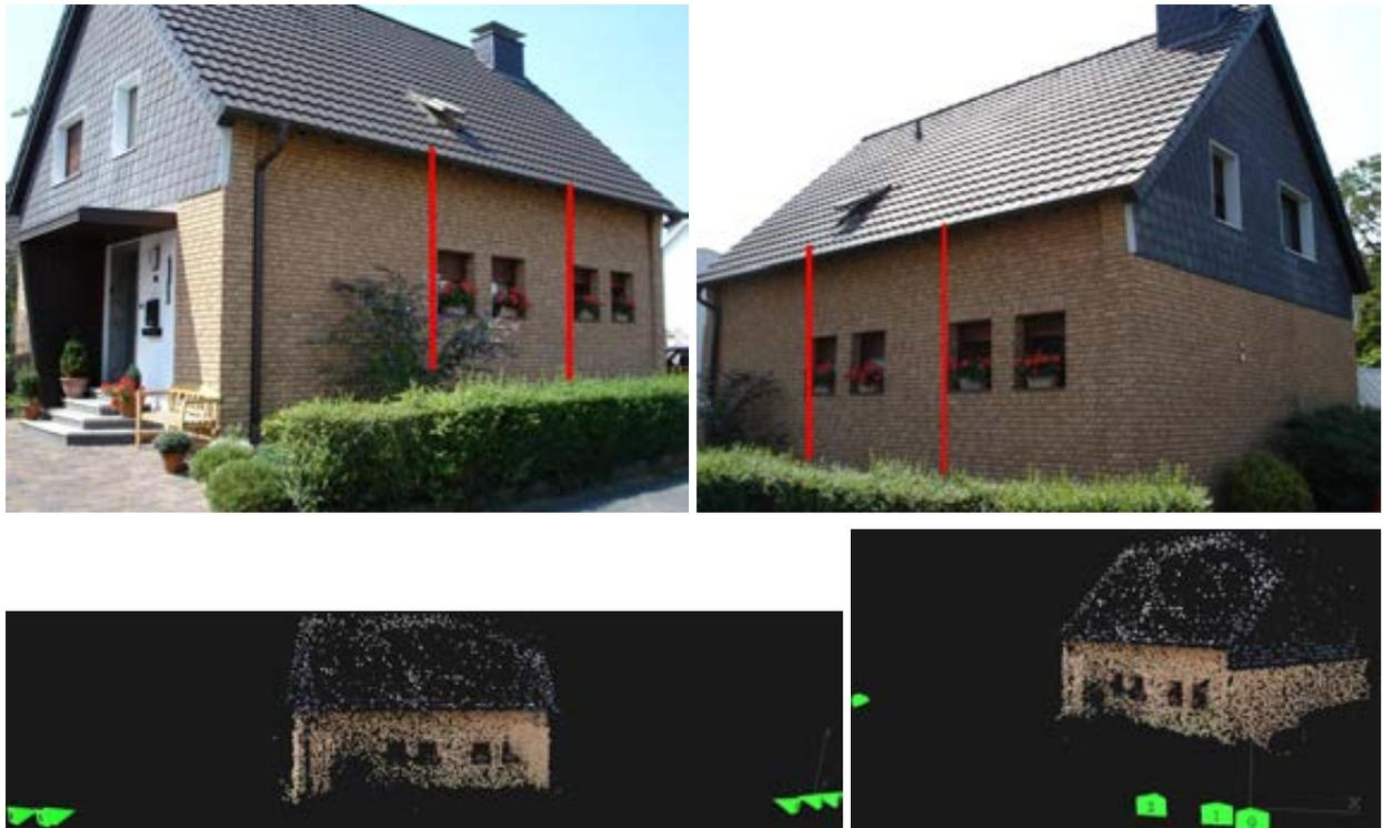
Abbildung 3.10: Beispiel für eine Aufnahmekonfiguration, bei der erhebliche lokale Maßstabsunterschiede auftreten (oben). Durch die große Blickwinkeländerung werden in den beiden Bildern die Objekte lediglich in einem kleinen Bereich (angedeutet durch rote Markierung) in ungefähr gleicher Auflösung dargestellt. Aufgrund der starken Texturierung ist in diesem Fall eine 3D Rekonstruktion auch auf der Grundlage von grundlegend nicht maßstabsinvarianten Förstner-Punkten möglich (unten).
