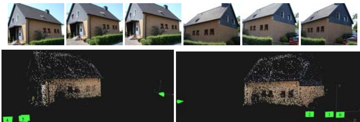
Abbildung 6.24: Ergebnis einer 3D Rekonstruktion einer Szene (unten) auf der Grundlage von sechs Bildern (oben) mit z.T. großer Blickwinkeländerung ( $\sigma_0 = 0, 10$  Pixel).
