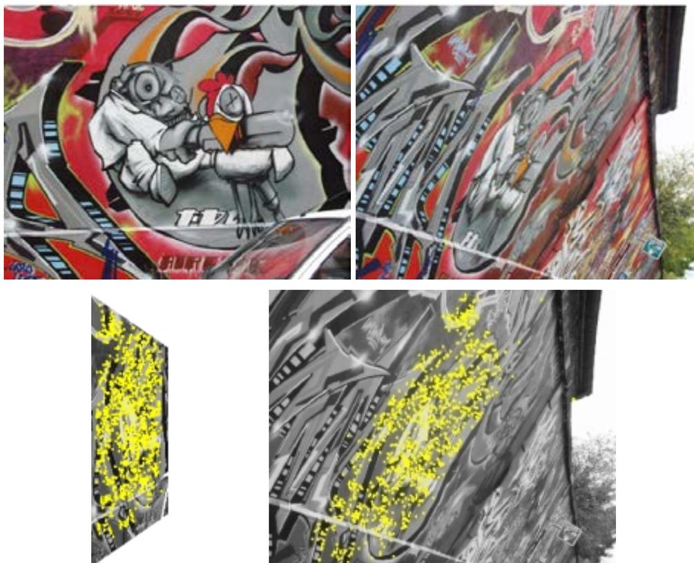
Abbildung 8.1: Verwendung einer projektiven Transformation zur Angleichung perspektiver Verzerrung. Oben: Originalbilder. Unten links: Transformiertes Bild (Simulierte  $60^\circ$  Drehung) und mittels FASIAM gefundene 1.043 Punktkorrespondenzen (gelb). Unten rechts: Punktkorrespondenzen im zweiten Bild (unverändert).
