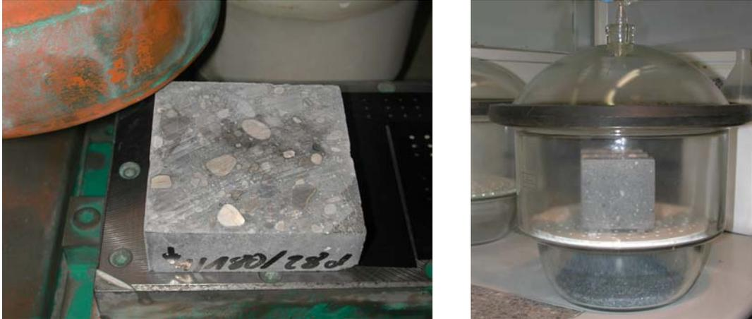
Abb. 61: Innenfläche eines Mikrorissprobekörpers beim Abschleifen in der Nassschleifmaschine (links); Trocknung der geschliffenen Mikrorissprobekörper im Exsikkator über Silikagel (rechts)
