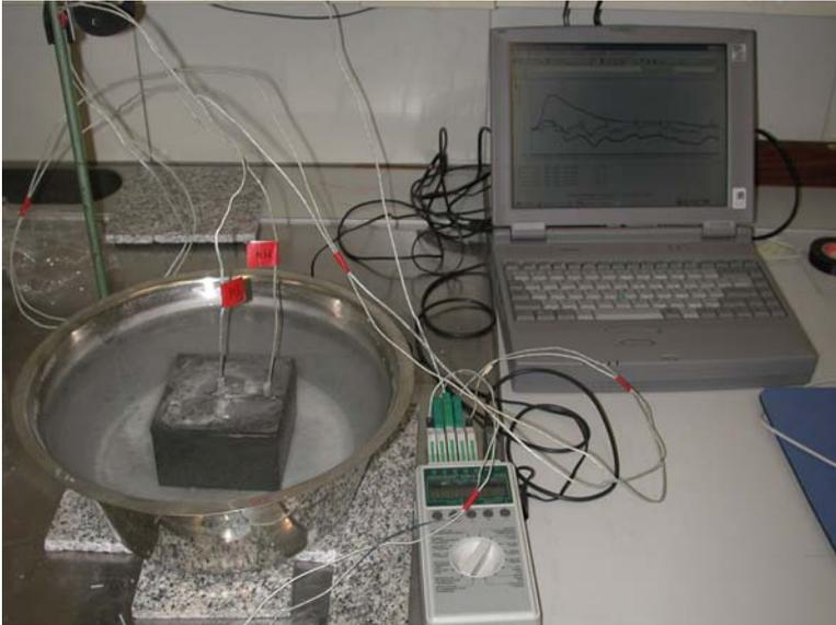
Abb. A 1: Probewürfel für die Temperaturmessung nach Norm bei Unterwasserlagerung mit Messgerät
