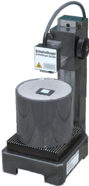
Abb. 94: Schwindkegel mit Laserdistanzmessgerät /149/
