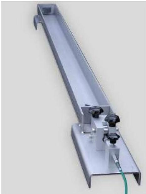
Abb. 91: Schwindrinne im unbefüllten Zustand, ohne Neoprenschaumvlies und ohne Teflonfolie /149/
