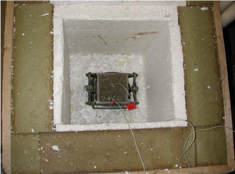
Abb. A 2: Probewürfel mit 10 cm Kantenlänge für die Temperaturverlaufsmessung bei quasi adiabatischer Lagerung vor dem Einbau
