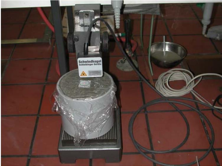
Abb. 96: Messung des dreidimensionalen autogenen Schwindens mit dem Schwindkegel
