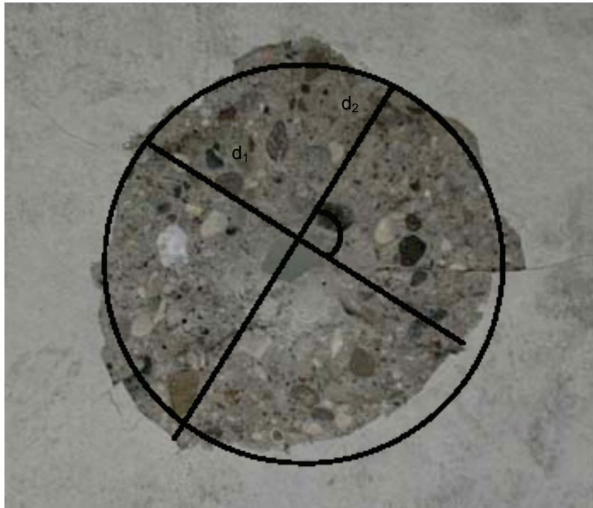
Abbildung A.5: Typischer Ausbruchkrater und Idealisierung zur Kreisgrundfläche eines Kegels durch d_1 und d_2
