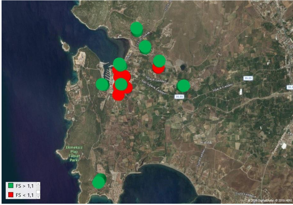
Şekil 8: İnceleme alanı verilerine ait 2. senaryoya (DD3 ve Mw=7) göre sıvılaşma risk haritası
