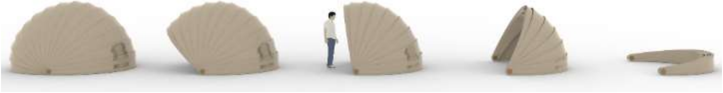
Şekil 17. Acil durum barınağının açılıp kapanması
