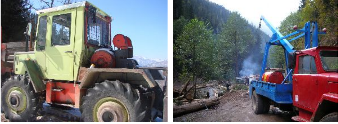
Şekil 3. MB Trac 900 Orman Traktörü ve Artvin vinci
