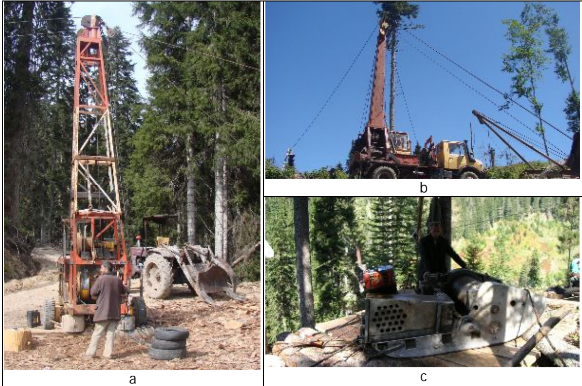
Şekil 4 . Artvin OBM'lüğünde kullanılan hava hatları (a-Koller K 300, b- Urus M III, c- Gantner
