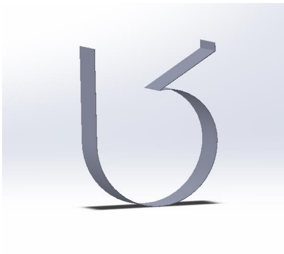
Slika 2.4: CAD model spiralnega ohišja
