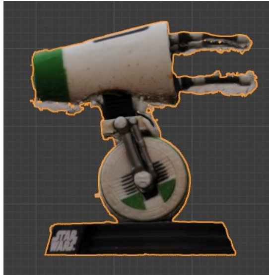
Slika 3.5: Odstranjeni glavni odvečni deli, model pa je še potreben obdelave
