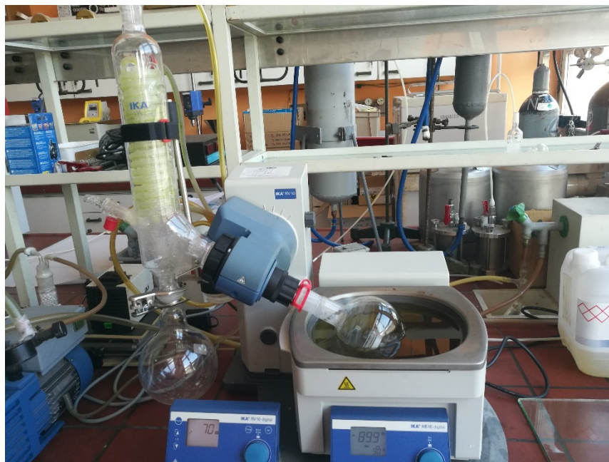
Slika 2-6. Izparevanje vode iz raztopine soli in MCM-41 na rotavaporju.
