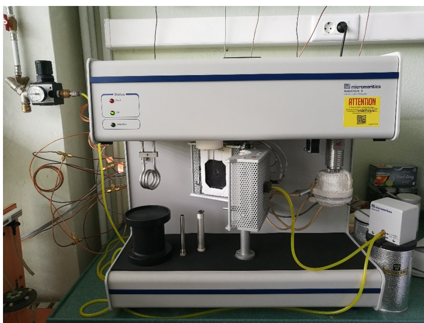
Slika 2-17. Naprava AutoChem II za NH 3 kemisorpcijo.
