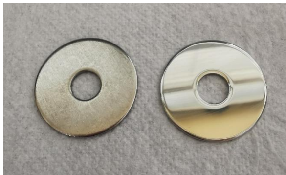
Slika 3.2: Primerjava vzorcev pred brušenjem (levo) in po njem (desno)
