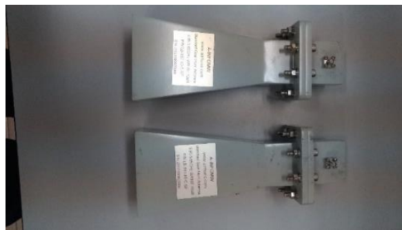
Fig. 3 - Horn antennas (Model: A-INFO LB-187-10, 3.95 -5.85 GHz)
