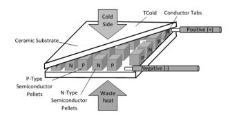
Fig. 1 - Peltier module.
