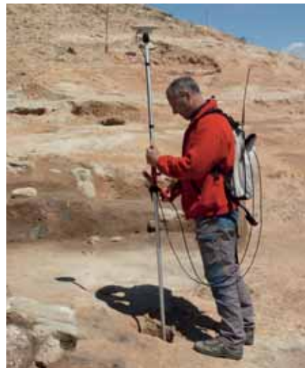
Figura 9. En las imágenes superiores toma de datos sobre vértices geodésicos de la zona para el cálculo de los parámetros de transformación de coordenadas. Abajo hito topográfico construido en el yacimiento para la instalación del receptor base y toma de puntos con el receptor móvil.
