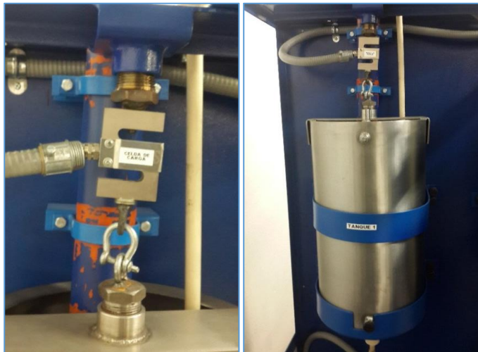
Figura 5.4 Celda de carga ensamblada en módulo de entrenamiento M-ECCI.
