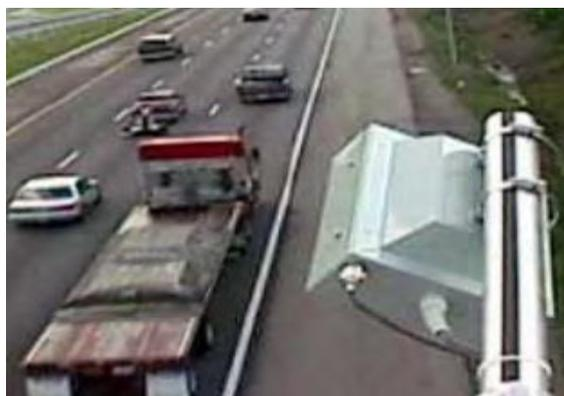
*Ilustración 17. Sensores acústicos*
