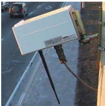
*Ilustración 13. Radar de microondas*
