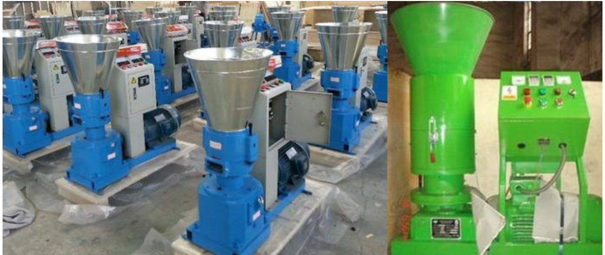
A la izquierda de color azul, peletizadora tipo dado; a la derecha de color verde, peletizadora tipo rodillo. Ambos diseños comercializados por MaquinPro de Colombia S.A.S. Fuente: http://www.maquinpro.com/peletizadoras.html
