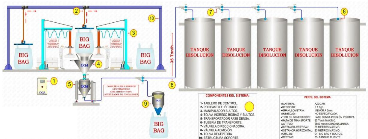
*Ilustración XXVIII esquema sistema oga-aje 5 (OGA transporte neumático, 2016)*
